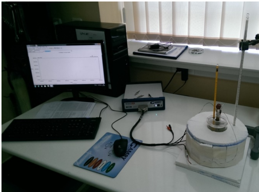
Slika 15: Eksperimentalna postavka za snimanje elektrohemijskih karakteristika superkondenzatora.
