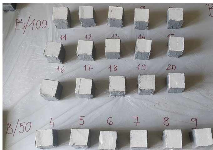
Слика 6.3: Припрема узорака за испитивање трајности (изглед након премазивања епоксидом)
