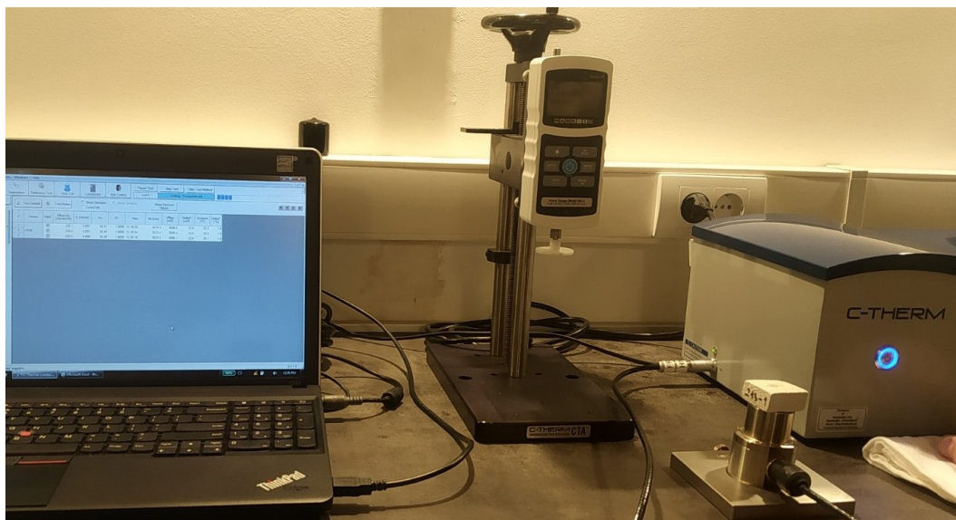
Слика 5.24: Испитивање коефицијента топлотне проводљивости
