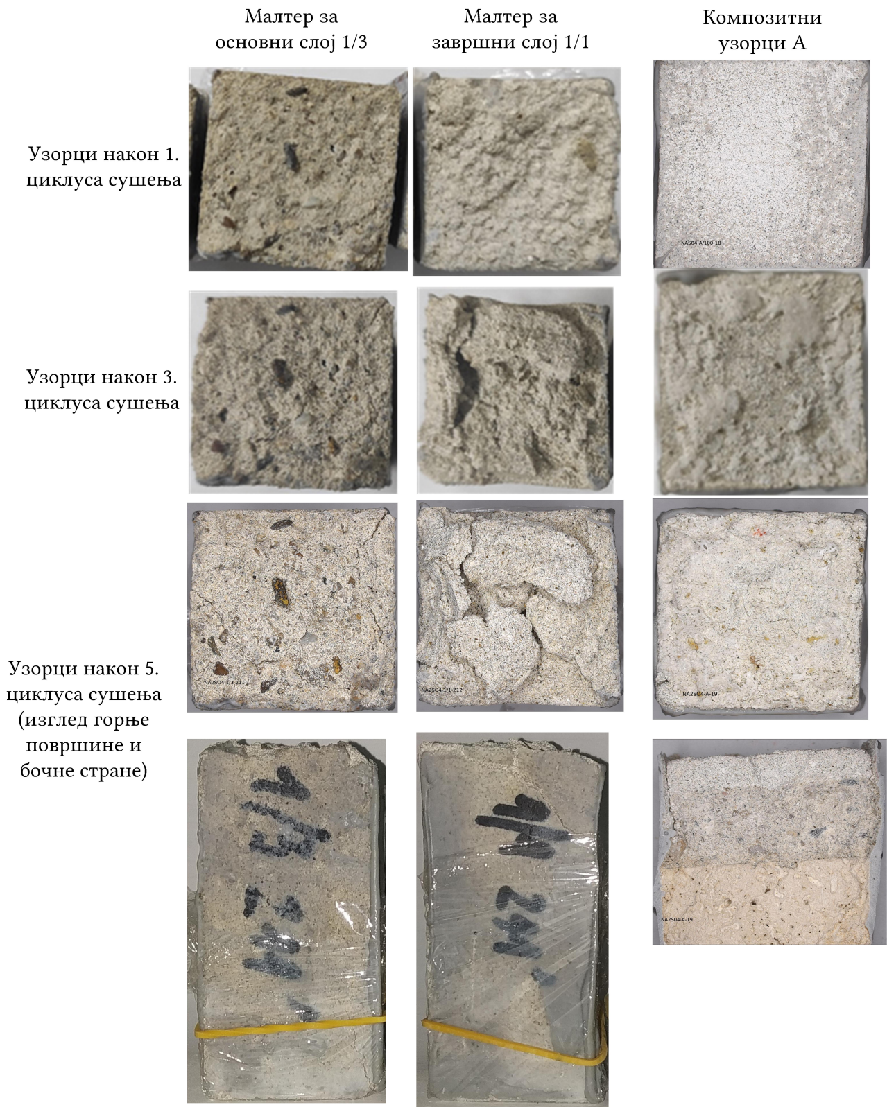
Слика Г.3: Композитни узорак А и призматични узорци 1/1 и 1/3 третирани раствором \text{Na}_2\text{SO}_4
