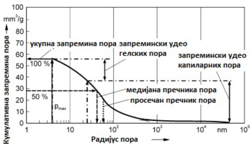
Слика 2.1: Важни параметри добијени методом живине порозиметрије [92]
