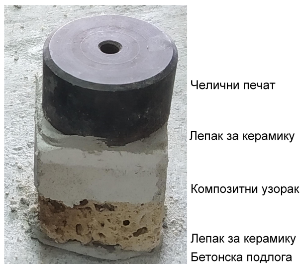
Слика 6.4: Припрема узорка за испитивање чврстоће приањања
