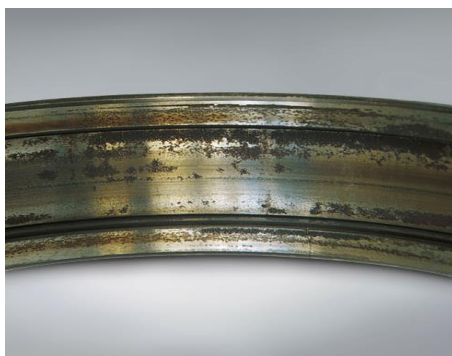
Слика 9 Оштећење лежаја корозијом [75]
