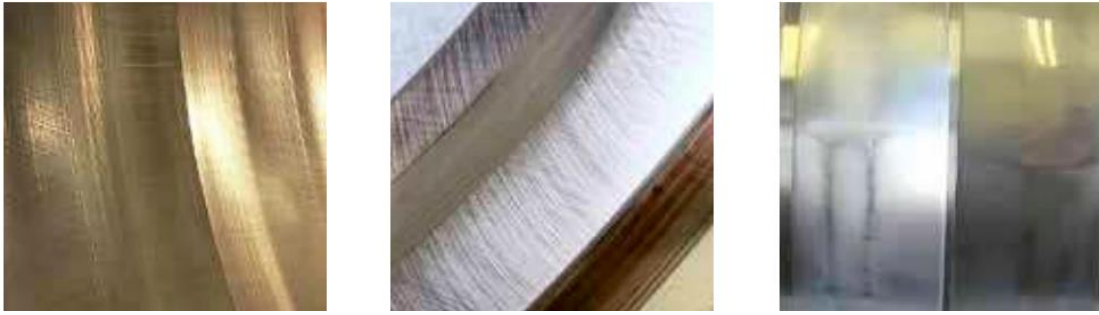
Слика 5 Оштећење стазе котрљања лежаја изазвано абразивним хабањем [73]
