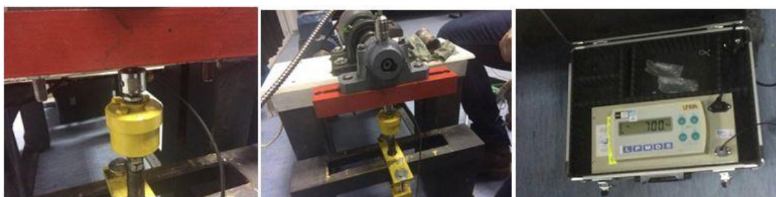
Слика 108 Задавање оптерећења испитиваних узорака лежаја
