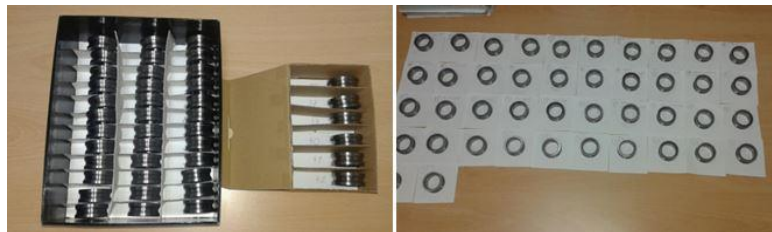
Слика 107 Нумерисани узорци унутрашњег прстена лежаја са нанетим оштећењима пре склапања
