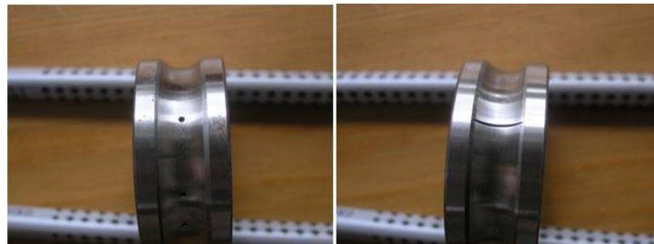
Слика 106 Израда оштећења у облику конуса и жлеба на унутрашњем прстену лежаја
