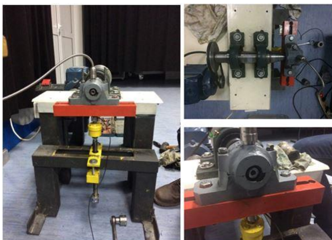
Слика 102 Уређај за динамичко испитивање котрљајних лежаја
