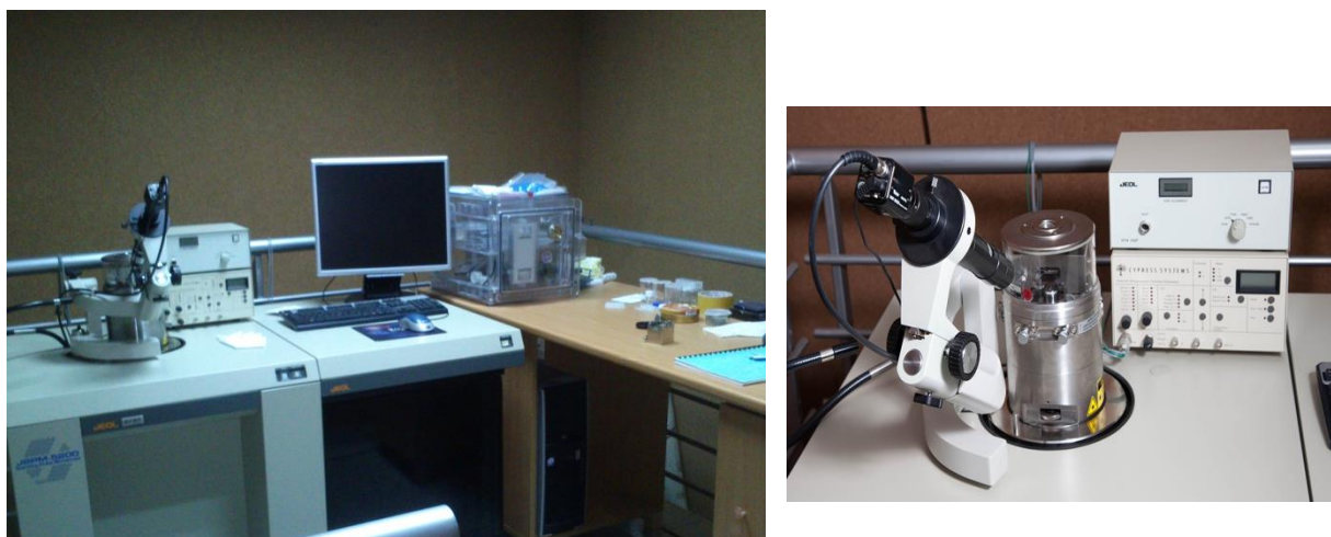
Слика 5.10. Скенирајући сондни микроскоп, ознаке JSPM 5200, произвођача JEOL из Јапан (Нанолаб, Машински факултет у Београду)
