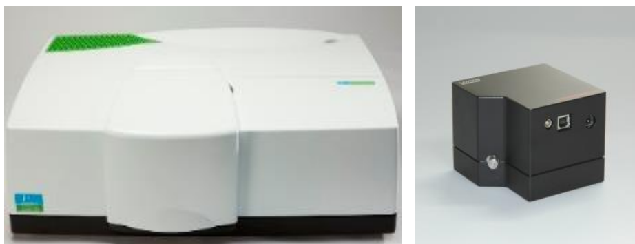
Слика 5.2. а) УВ-Вис-НИР спектрометар Lambda 950 , Perkin Elmer ; б) УВ-Вис мини спектрометар TM-C10082CA Hamamatsu
