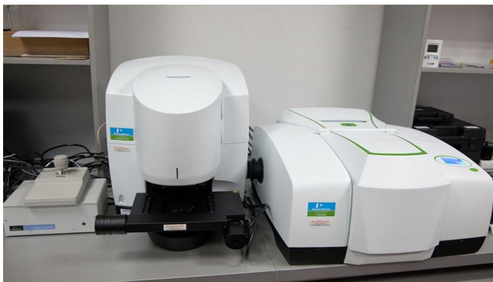
Слика 5.5. ФТИР систем за микроспектроскопију ( Perkin Elmer FTIR Spotlight 400 ), Нанолаб, Машински факултет, Универзитет у Београду
