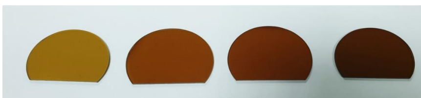
Слика 4.3. Узорци наноконтропитних материјала: 1) ПММА са 0,025mas%, 2) са 0,05 mas%, 3) са 0,075 mas%, 4) са 0,100 mas%
