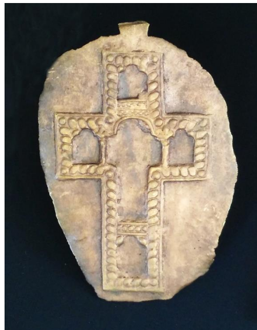
Сл. 543. Модел за калуп окова крста из радионице ужичког златара Сретена Петровића
