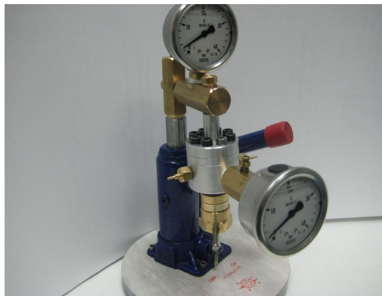
Slika 3.4 Izgled bioreaktora sa hidrostatičkim pritiskom kroz faze razvoja, prototip 1
