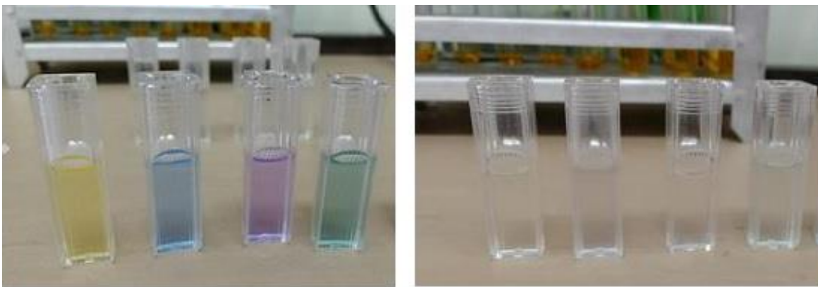
Slika 76. Promena boje u kivetama sa odabranim bojama i lakazom iz T. versicolor imobilisanom na Lifetech™ ECR8285F nosač
