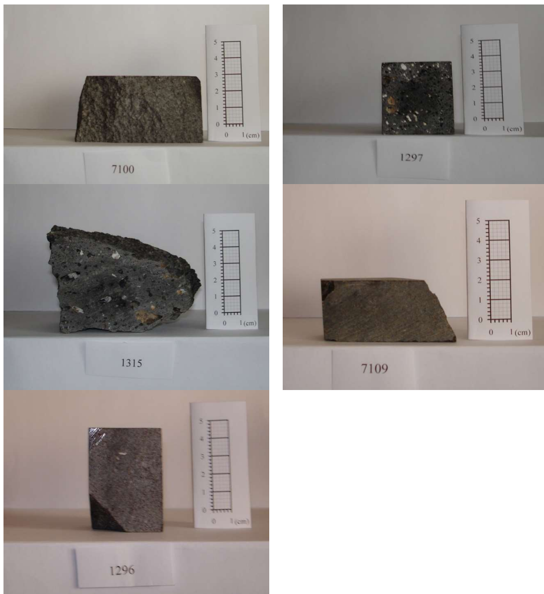
Slika 5.4: Pripremljena probna tela paralelopipednog oblika za merenje brzine longitudinalnih ( V_p ) i transverzalnih ( V_s ) talasa
