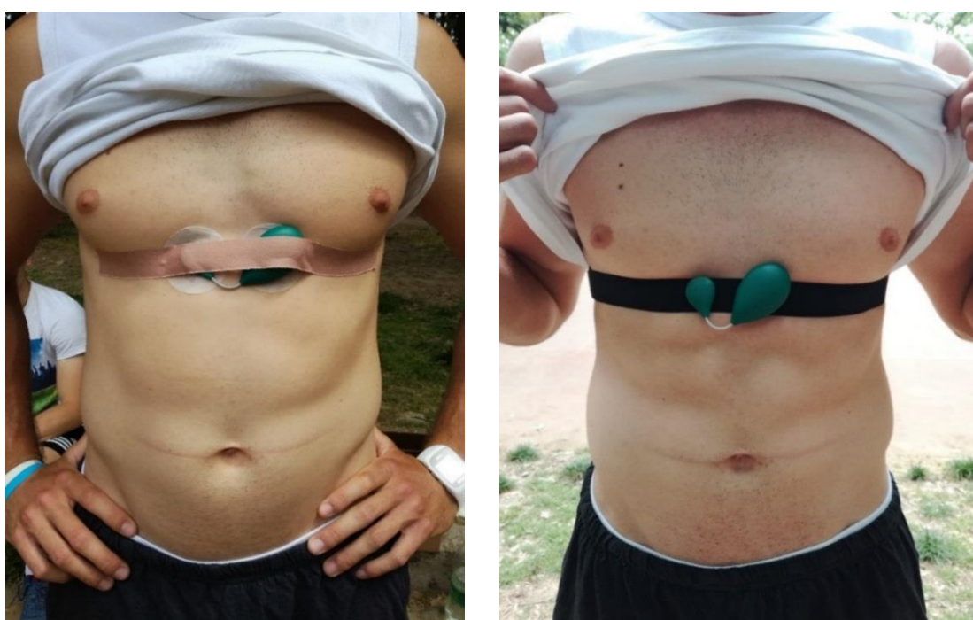
Slika 10. Način postavljanja i pričvršćivanja elektroda i uređaja u prvom (levo) i u drugom testu (desno)
