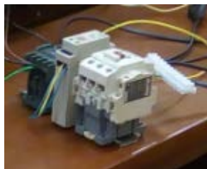
Slika 7.6: Kontaktor za simuliranje kratkih spojeva
