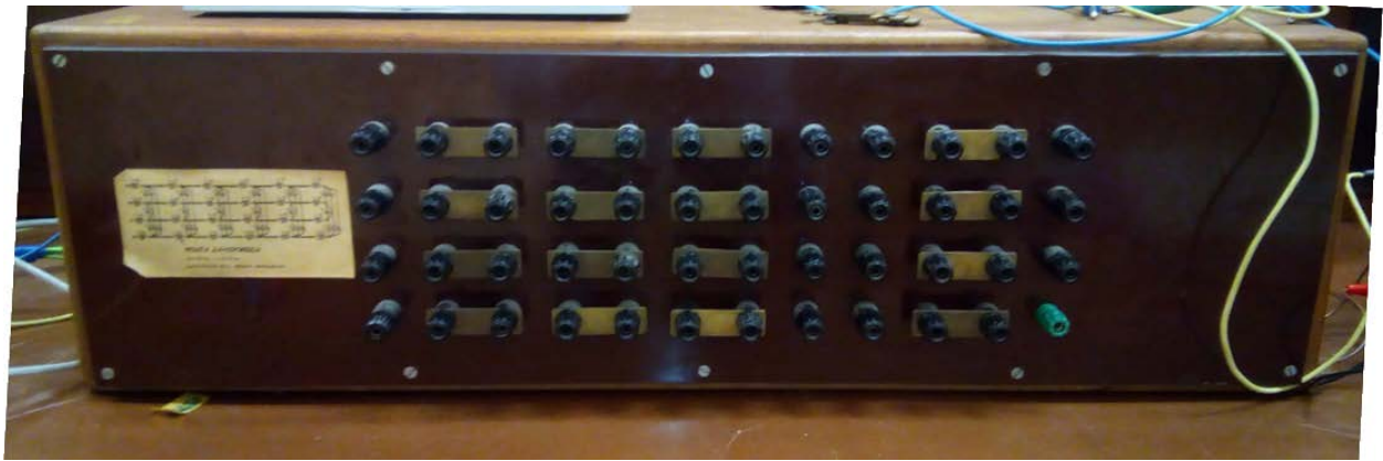
Slika 7.2: Fizički model voda sa šest deonica u drvenom kućištu
