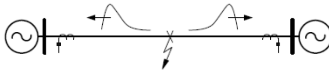
Slika 3.5: Prostiranje visokofrekventnog talasa po vodu prilikom nastanka kvara
