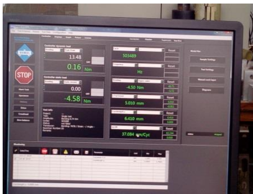
Slika 6.46 RUMUL-ov softver korišćen za eksperiment, sa svim bitnim parametrima (moment savijanja, trenutna dužina prsline, brzina rasta prsline, trenutni broj ciklusa)
