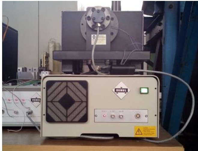
Slika 6.47 Fraktomat 7609/213, na kome su ispitane epruvete sa zamornom prslinom
