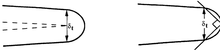
Slika 2.11 Definicija otvaranja vrha prsline (CTOD): rastojanje lica prsline na mestu vrha (levo), presek sa otvorom od 90° [6]
