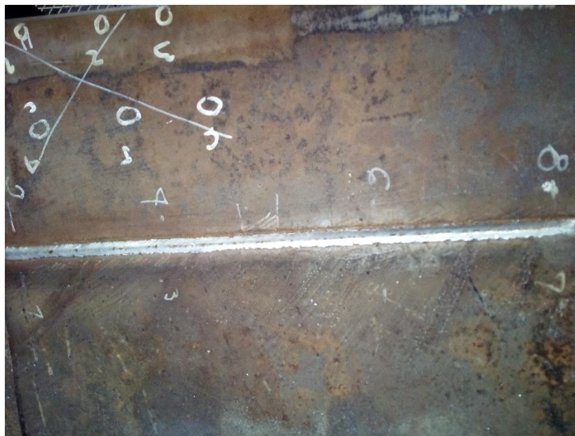
Slika 6.1 Zavarena ploča sa obeleženim mernim mestima za kontaktno merenje temperature
