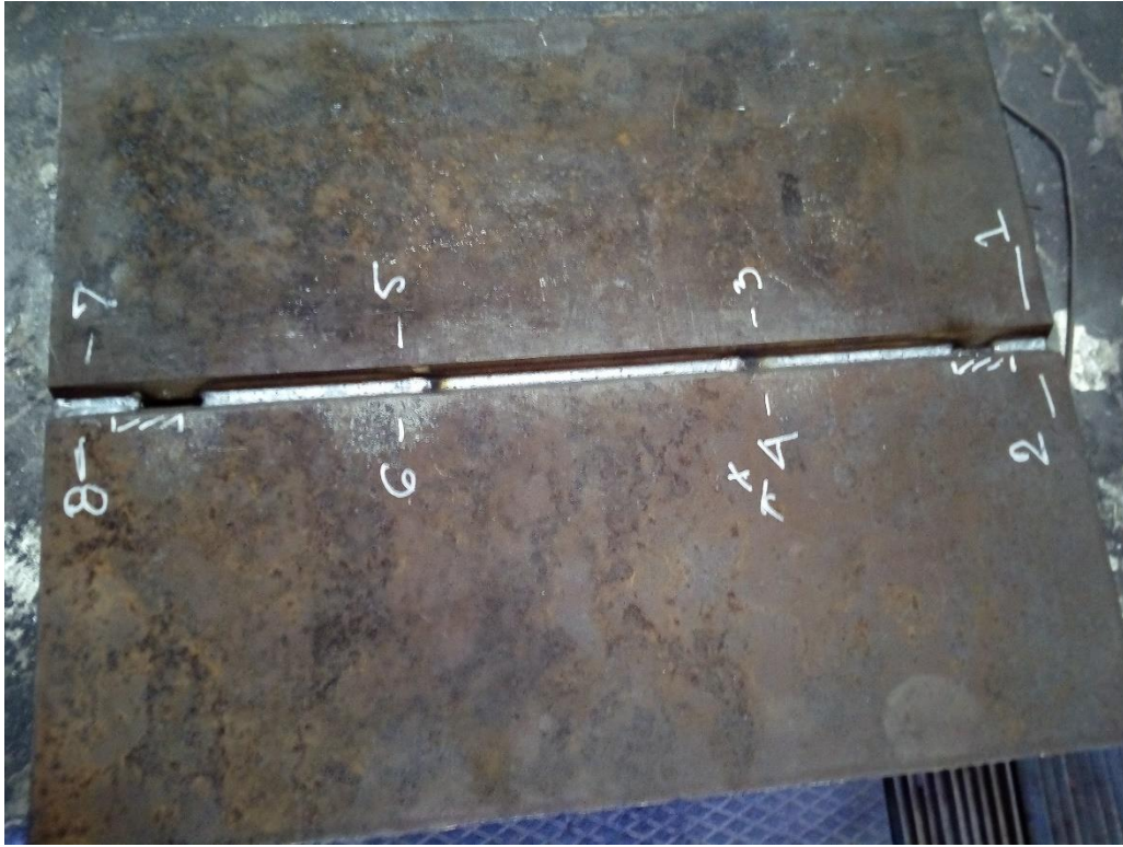
Slike 6.7 Položaji mernih mesta za temperaturu na zavarenoj ploči
