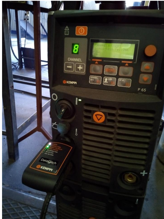
Slike 6.5 Postavka zavarivanja (gore) i aparat za MIG postupak sa loggerom (dole)
