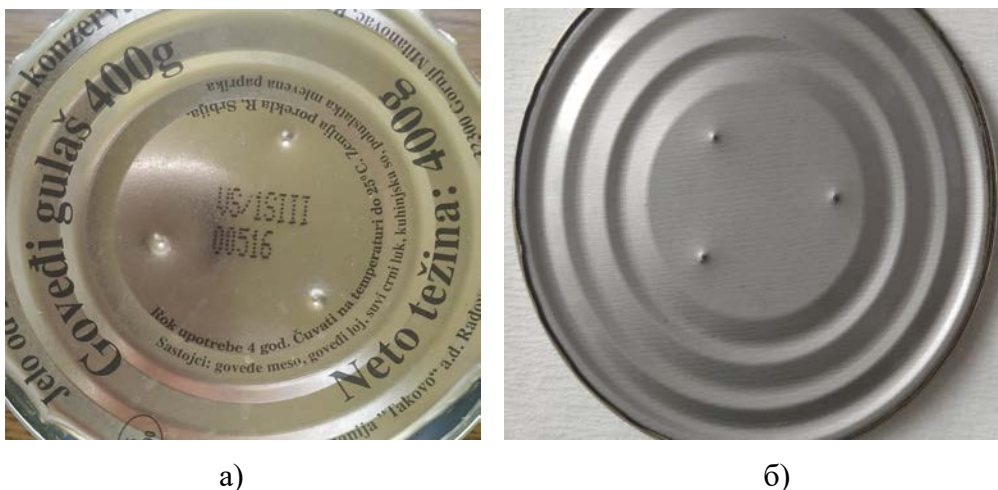
Слика 11. Индукована оштећења на поклопцу конзерве: а) спољашња површина, б) унутрашња површина
