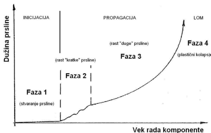
Slika 2.7. Faze stvaranja i rasta prsline do loma komponente
