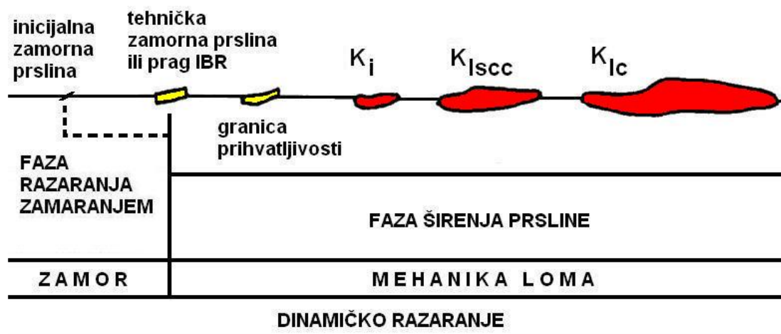
Slika 2.5. Karakteristike dinamičkog razaranja i zamorne prsline u njenom razvoju
