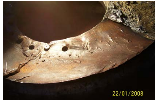
b) Prolazna prsline turbinskog vratila [80]
