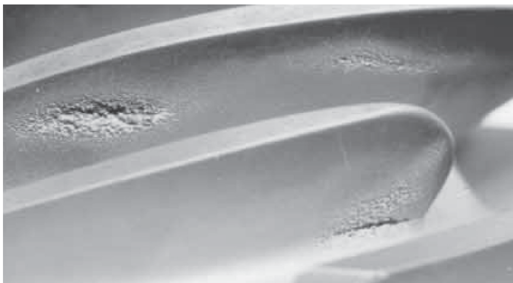
Slika 2.41. Oštećenja pod dejstvom kavitacije na lopatici protočne pumpe [129]
