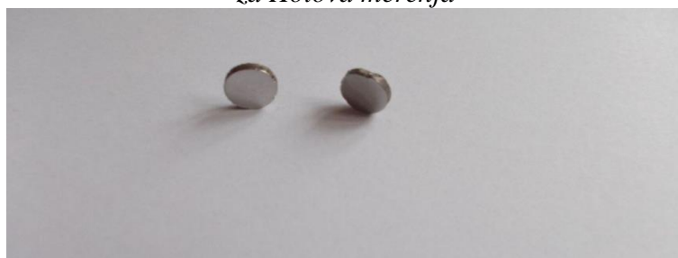
Slika 30. Prikaz sečenih uzoraka kružnog poprečnog preseka 1/5 ( \perp ) i 2/2 ( \perp ) iz ingota
