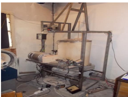
b) rast monokristala u peći
