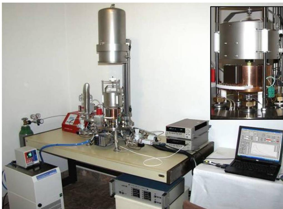
Slika 16. Izgled Z merača; umetnuta slika u gornjem desnom uglu prikazuje topli i hladni blok sa uzorkom smeštenim između (Bernik i Pribošek, 2013)
