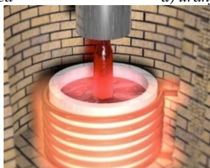
e) izvlačenje monokristala iz rastopa
