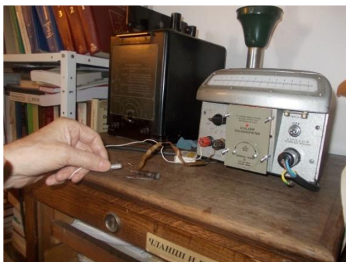
Slika 14. Određivanje tipa većinskih nosilaca naelektrisanja metodom vruće tačke
