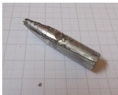
Slika 48. Prikaz cepanog ingota po pravcu kristalizacije a) i b)
