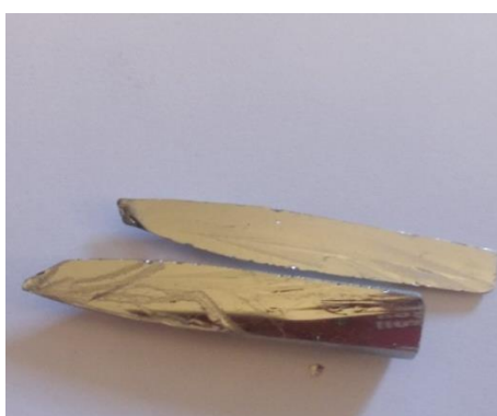
Slika 48. Prikaz cepanog ingota po pravcu kristalizacije a) i b)
