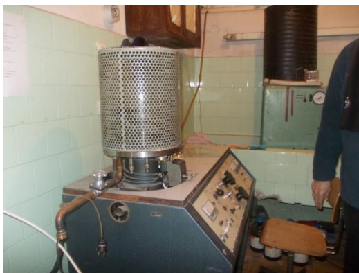
a) vakum sistem za vakumiranje ampula i naparavanje tankih filmova
