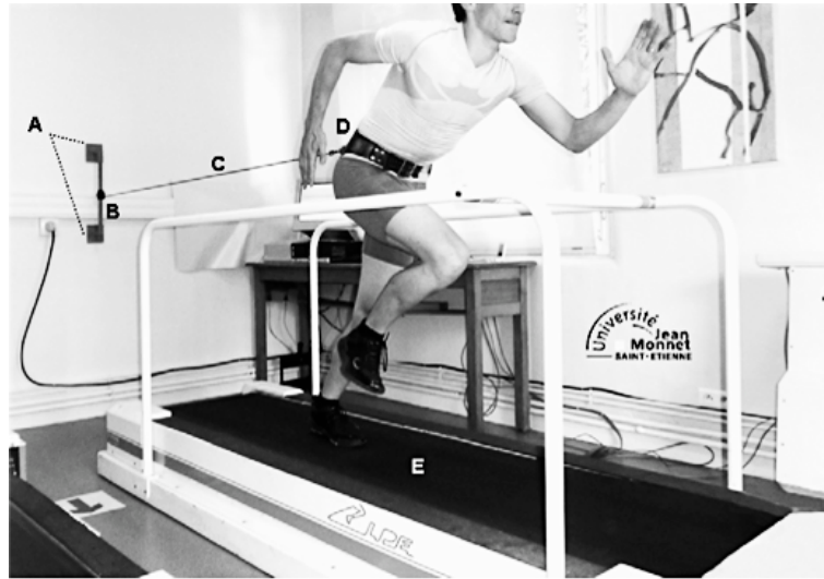
Слика 16. Извођење спринт теста на тредмилу: А – метални зидни носач омогућава индивидуализацију висине фиксне тачке према висини испитаника; В – фиксна тачка, место где се уже везује за ослонац; С – нееластично уже за пењање; D – појас за дизање тегова; Е – трака тредмила (Morin et al., 2010)
