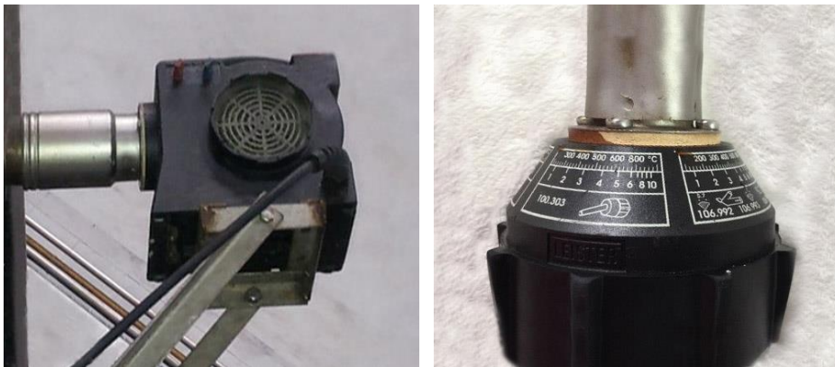
Slika 6.8. Industrijski fen model BAK Compact (5102602) maksimalne temperature 800\text{ °C} i maksimalnog protoka vazduha 800\text{ dm}^3/\text{min} koji je korišćen za kalibraciju Venturijevog pirometra [209].
