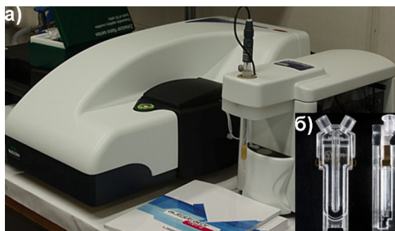
Слика 6.9. а) Уређај Zetasizer Nano ZS коришћен за мерење средње величине честица, расподеле величина честица по интензитету и зета потенцијала; б) Универзална капиларна ћелија за мерење зета потенцијала.
