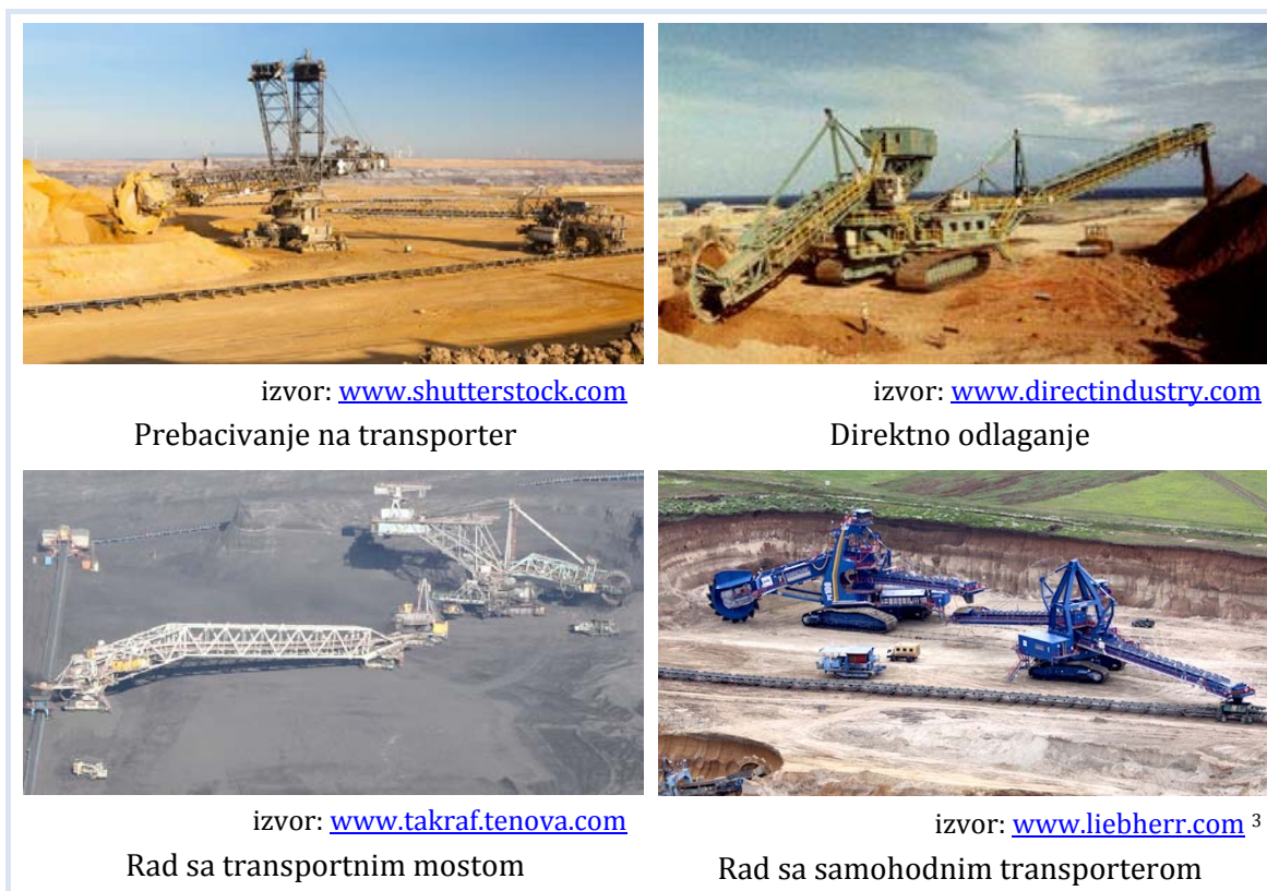
Slika 3.13 Različiti načini rada rotornog bagera
