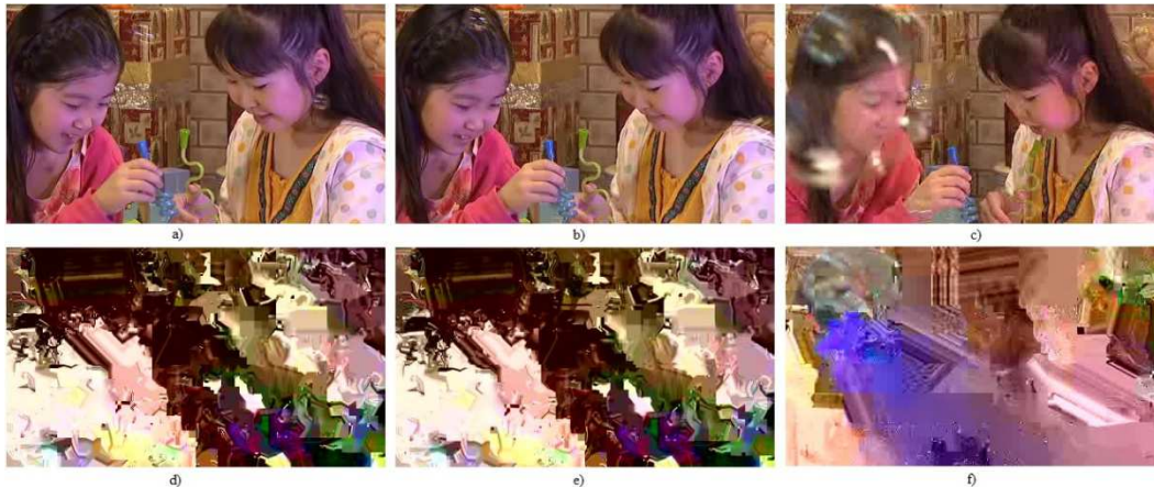
Slika 30. Frejmovi #0 #8 i #32 (I, B i B frejm respektivno) BlowingBubbles sekvence sa i bez primenjenog algoritma selektivnog šifrovanja: a) Originalni frejm #0, b) Originalni frejm #8, c) Originalni frejm #32, d) Selektivno šifrovani sa CSPS frejm #0, e) Selektivno šifrovani sa CSPS frejm #8, f) Selektivno šifrovani sa CSPS frejm #32
