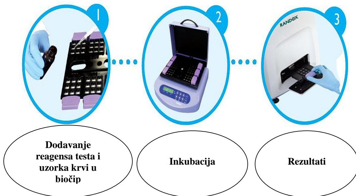
Slika 5. 1) Dodavanje reagensa testa i uzorka u biočip; 2) 54 biočipa se smešta u inkubator koji obezbeđuje optimalne uslove; 3) nosač biočipa se ubacuje u polu-automatski analizator Randox Evidence Investigator . Preuzeto i obrađeno iz: Randox Biochip Array; Randox Clinical Laboratory Services ( www.randox.com ).
