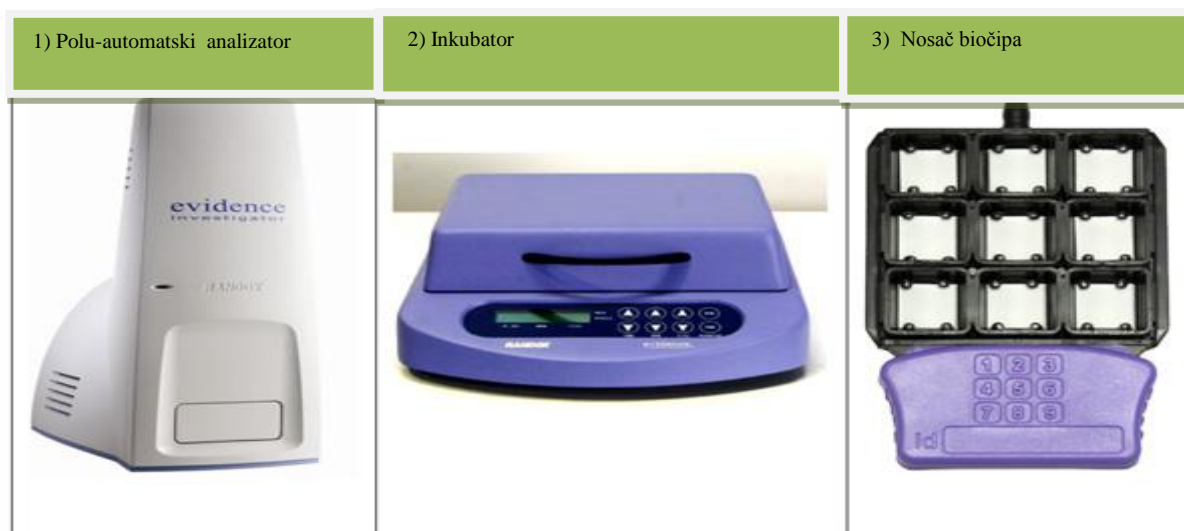
Slika 4. 1) Polu-automatski analizator; 2) inkubator obezbeđuje kontrolisane temperaturne uslove; 3) Nosač biočipa. Preuzeto i obrađeno iz: Randox Biochip Array ; Randox Clinical Laboratory Services ( www.randox.com ).
