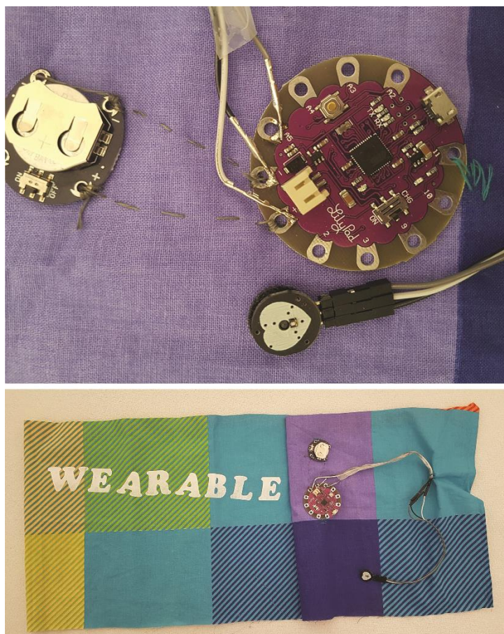
Слика 28. Повезане компоненте Интернета интелигентних уређаја и коначан изглед wearable -мараме (Rodić-Trmčić, Labus, Barać, Popović, & Radenković, 2017)
