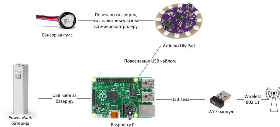
Слика 13. Шематски приказ компоненти wearable система за мерење откуцаја срца (Rodic-Trmcic, Labus, Bogdanovic, Despotovic-Zrakis, & Radenkovic, 2018)
