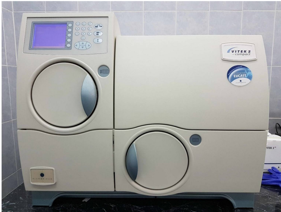
Slika 25. Uređaj za automatsku identifikaciju i test osetljivosti kulture bakterije (Izvor Služba za laboratorijsku dijagnostiku – mikrobiološka laboratorija, KBC „Dr Dragiša Mišović – Dedinje“).
