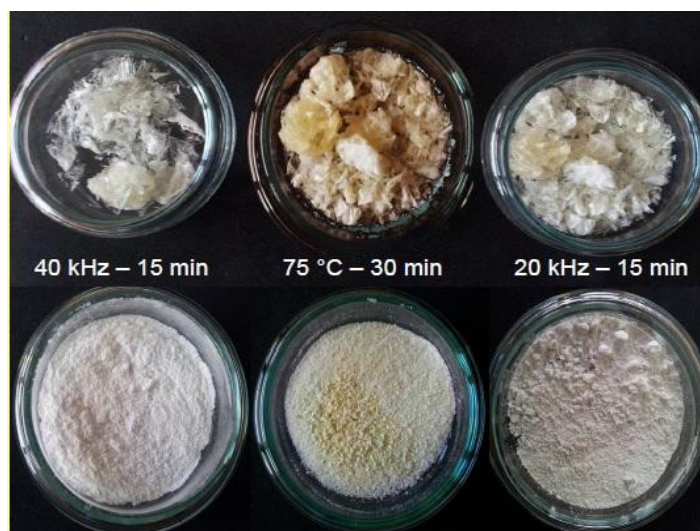
Slika 7.34. Fotografije osušenih hidrolizata liofilizacijom (gore) i sprej sušenjem (dole). Liofilizacija je vršena pri konstantnim usvojenim parametrima: glavno sušenje 12 h na -30 °C pri 0,25 mbar; finalno sušenje 5 h na 35 °C pri 0,25 mbar. Sprej sušenje je vršeno pri sledećim uslovima: T_{ul}/T_{izl} 180/90 °C, protok tečnosti 6 ml/min, protok komprimovanog vazduha za disperziju tečnosti 800 l/h. Hidrolizati su dobijeni enzimskom hidrolizom u jednostepenom procesu sa alkalazom pri čemu su izvorni proteini bili pretretirani sa tri različita pretretmana.
