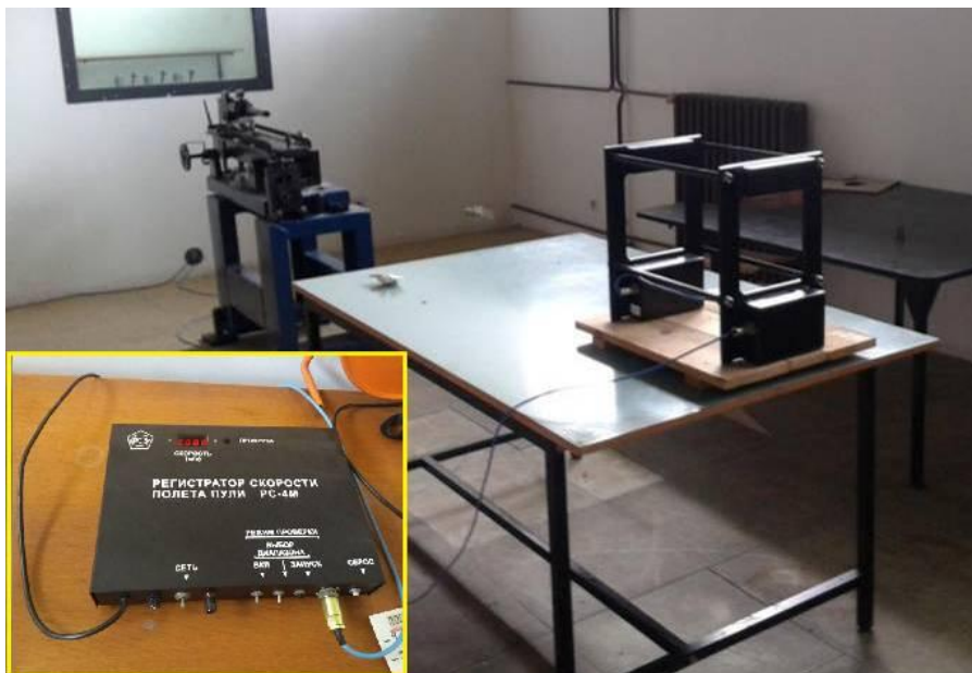
Slika 56. Uredjaj za merenje brzine zrna / metka: RS-4M ( -4 " " - )
