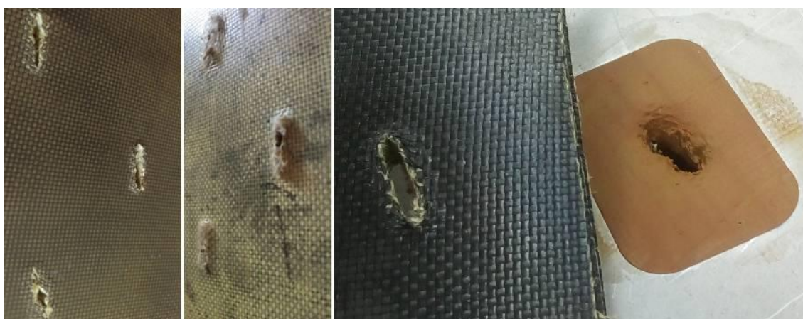
Slika 128. Uzorci nakon uboda noža i otisak u balističkoj glini
