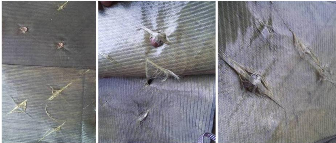
Slika 114. Uzorci za meku balistiku nakon upucavanja, XP S103/IF-WS 2
