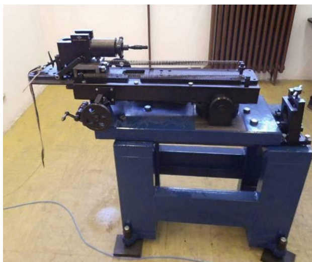
Slika 57. Uredjaj za gadjanje sa mogu no– u upotrebe razli itih opitnih cevi (levo) i nosa uzoraka sa balisti kom glinom i postavljenim uzorkom (desno)
