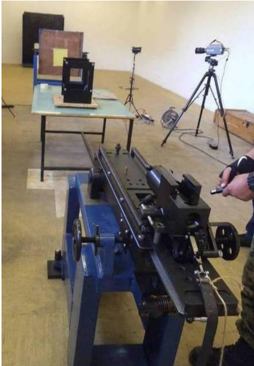
Slika 55. Postavka uređaja za gađanje, uređaja za merenje brzine zrna, uzorka na nosaču i ultra-brze kamere
