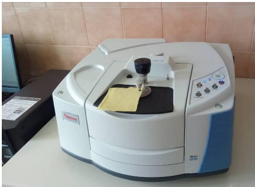
Slika 47. Ure aj FTIR sa ATR Thermo Nicolet iS10 sa uzorkom aramidne tkanine
