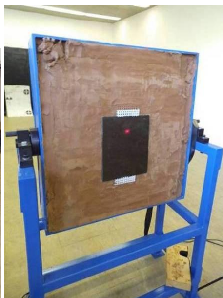
Slika 57. Uredjaj za gadjanje sa mogu no– u upotrebe razli itih opitnih cevi (levo) i nosa uzoraka sa balisti kom glinom i postavljenim uzorkom (desno)
