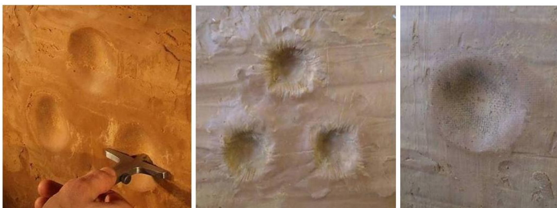
Slika 113. Merenje dubine uboja (levo), uboj Kevlara za meku balistiku (sredina) i kompozita za vrstu balistiku (desno)
