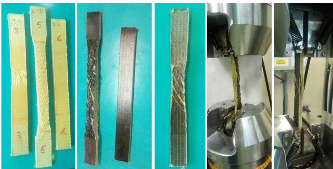
Slika 112. Izgled uzorka Aramid/PVB i Aramid/PVB/IF-WS 2 nakon ispitivanja zatezne vrste i u klemama kidalice po nastanku loma
