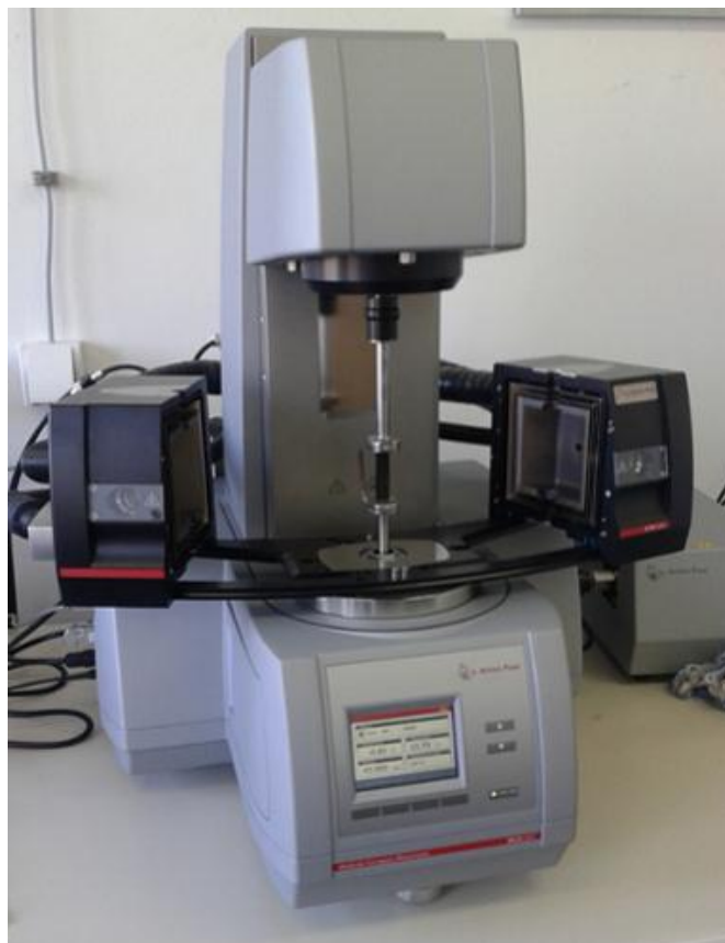
Slika 50. Modular Compact Rheometer MCR-302, Anton Paar, sa komorom za regulisanje temperature, sa uzorkom u klemama
