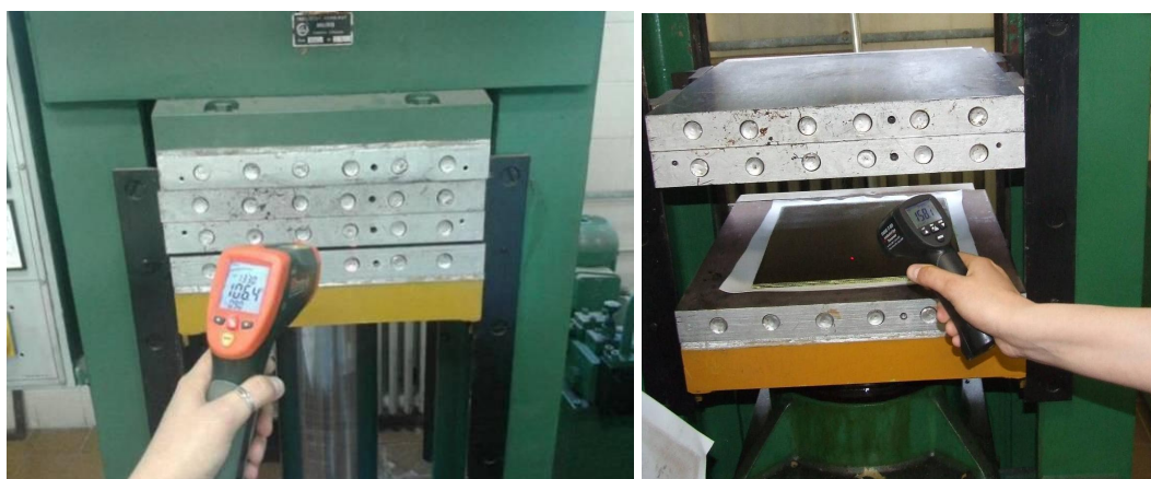
Slika 44. Pra enje temperature na greja ima prese opti kim pirometrom
