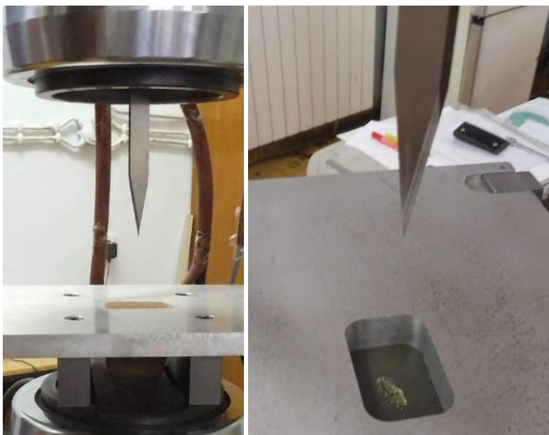
Slika 59. Ispitivanje otpornosti kompozita na ubod noflem
