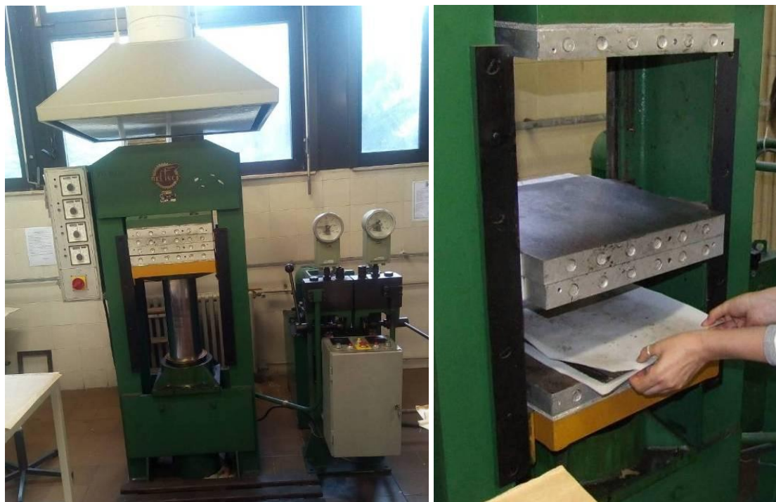
Slika 39. Hidrauli na presa Beli- e i presovanje uzoraka za-ti enih pomo u teflonske folije
