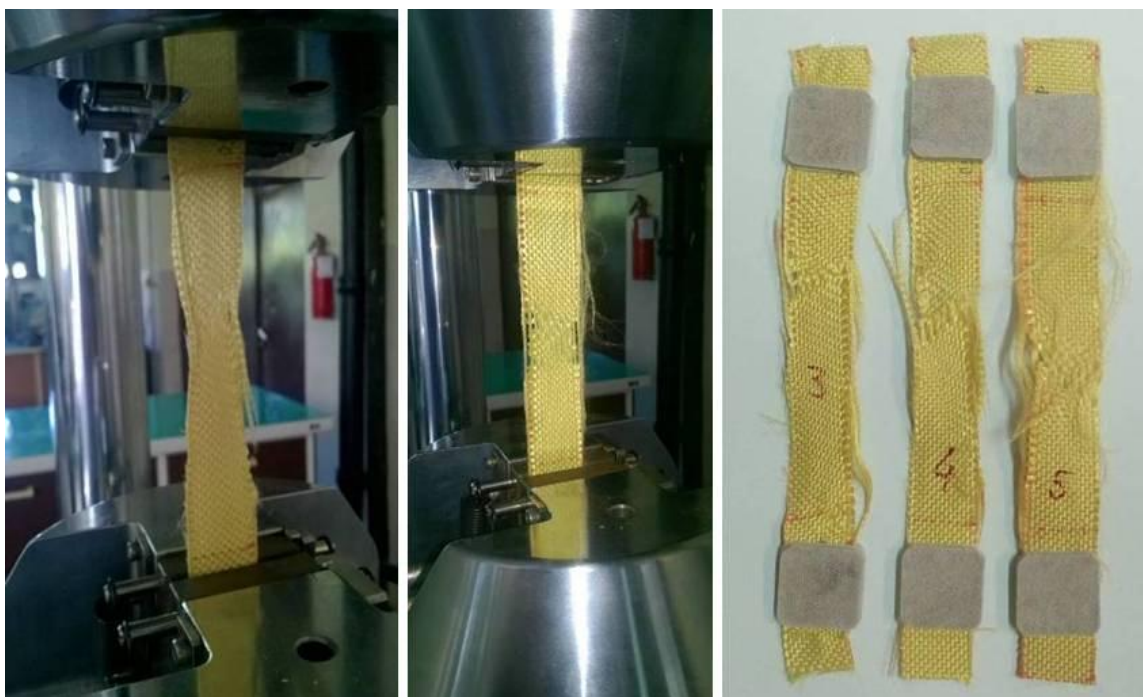
Slika 111. Uzorci aramidne tkanine Prepreg 258HPP u toku i nakon ispitivanja istežanjem
