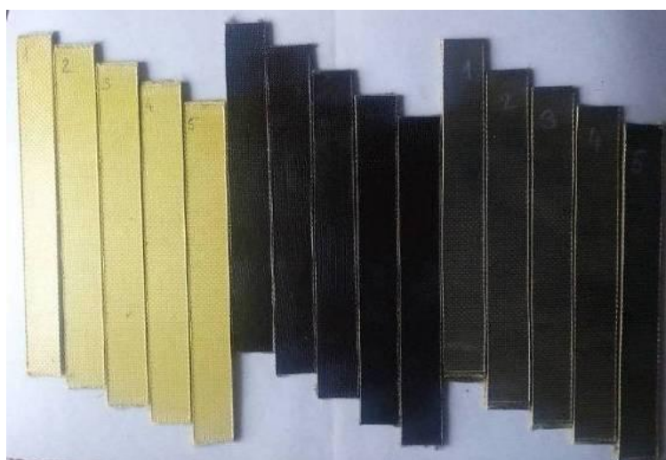
Slika 54. Uzorci za ispitivanje zatezne vrsto e
