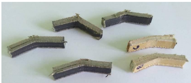
Slika 104. Uzorci nakon udara TM arpijevog klatna
