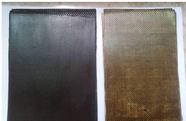
Slika 42. Lice i nali je presovanog uzorka Kevlar Prepreg 258HPP/PVB/IF-WS 2
