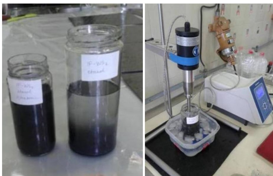
Slika 37. Levo: dispergovan i nedispergovan IF- WS_2 u etanolu, desno: dispergovanje estica pomo u ultrazvu nog procesora Badelin SonoPuls
