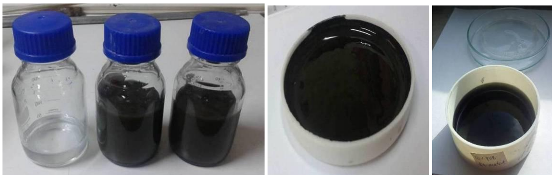
Slika 38. Pripremljeni rastvori i posude sa kompozitnim filmom PVB/ WS_2 nakon otparavanja rastvara a
