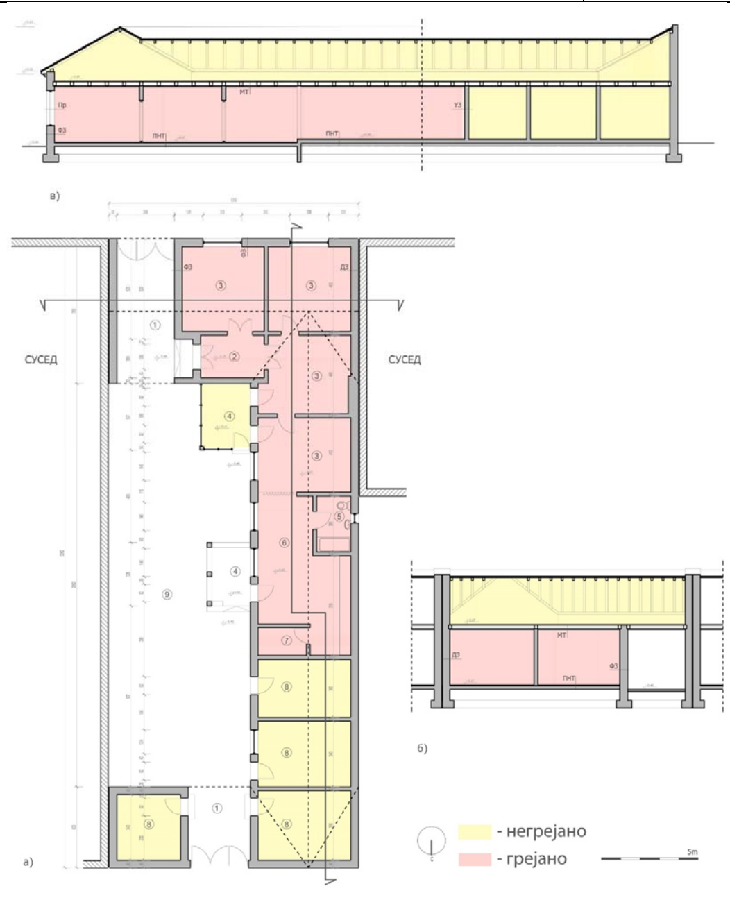
а) основа приземља б) попречни пресек в) подужни пресек легенда ознака просторија: 1- улаз (ајнфорт), 2- ходник, 3- соба, 4 - веранда, 5 – купатило, 6 – кухиња са трпезаријом/дневни боравак, 7 - остава, 8 – помоћне просторије, 9 - двориште
