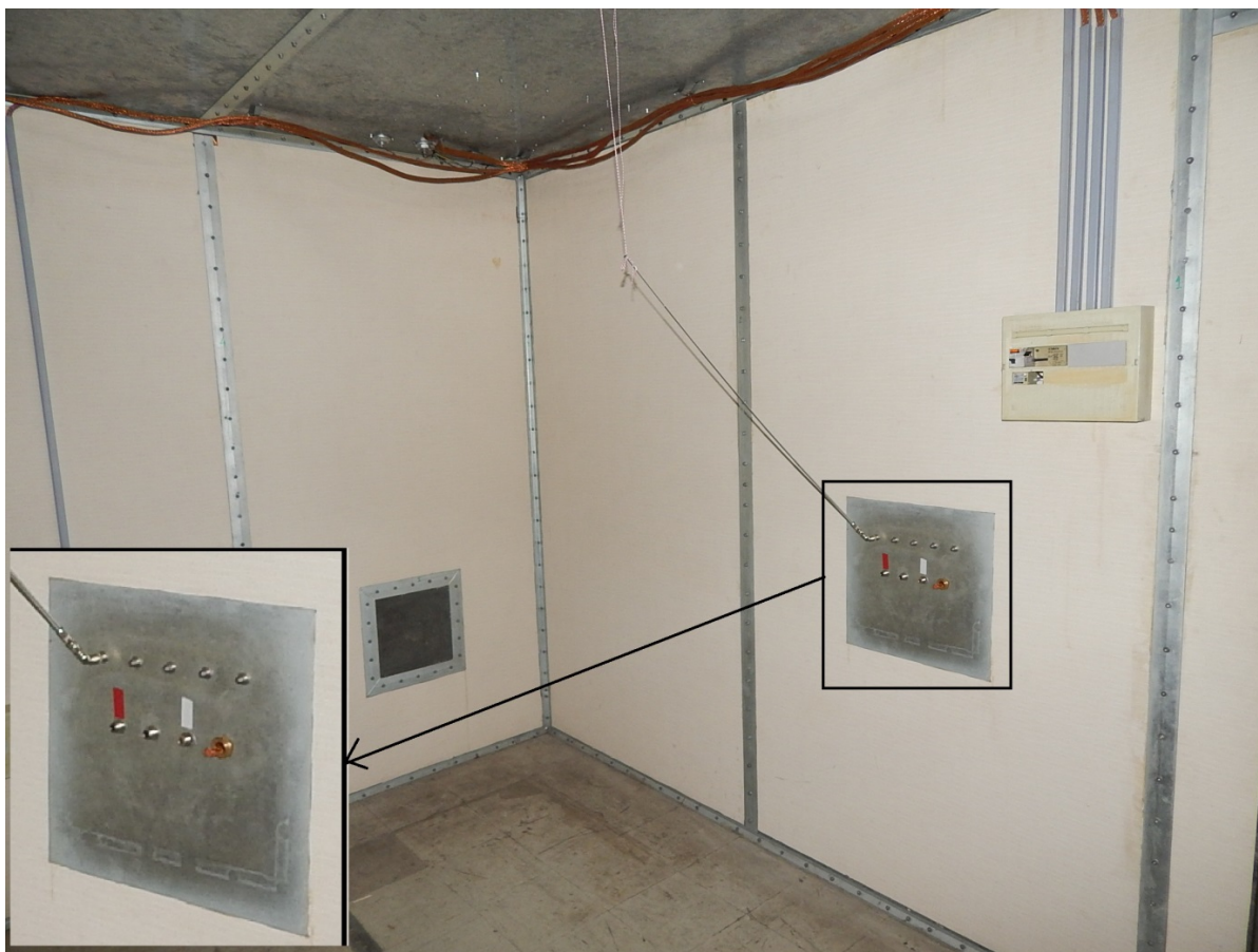
Slika 3.27 Položaj kose monopol-antene u Faradejevom kavezu pri merenjima u proširenom frekvencijskom opsegu
