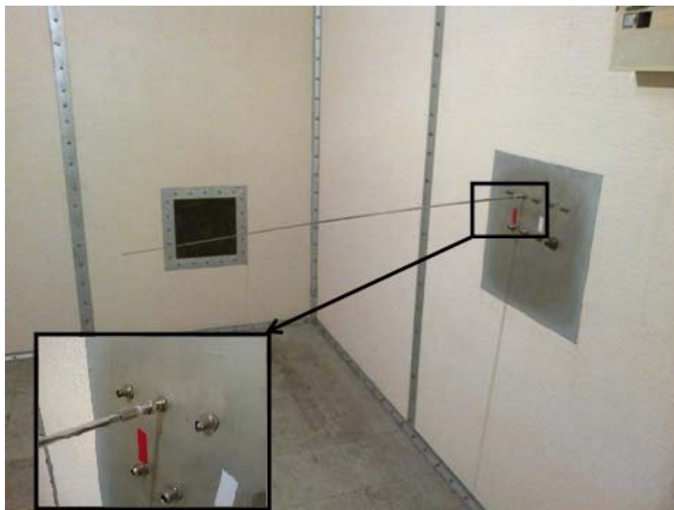
Slika 3.6 Položaj horizontalne monopol-antene u Faradejevom kavezu
