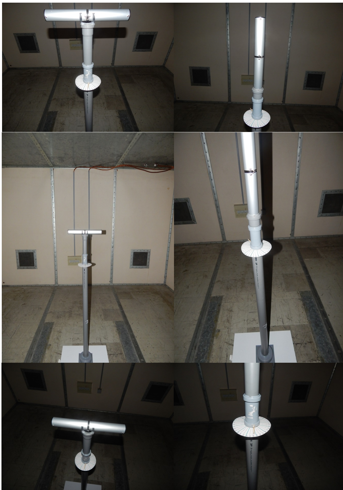
Slika 4.11 PVC obrtno postolje sa nosačem dipola i uglomerom za vertikalno i horizontalno orijentisan dipol
