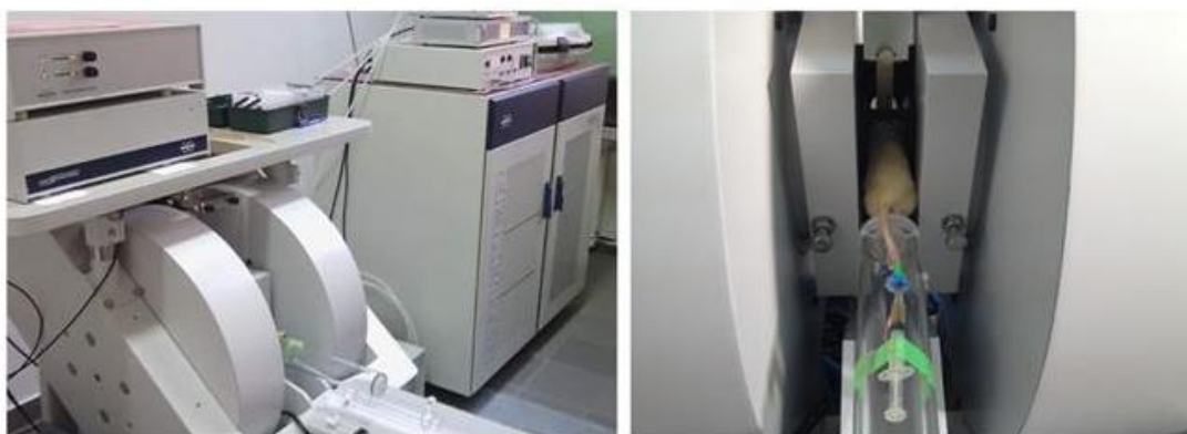
Slika 10. Eksperimentalna postavka za EPR spektroskopiju in vivo . Slike predstavljaju prikaz EPR uređaja (levo) i položaj životinje u rezonatoru tokom snimanja (desno)
