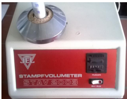
Слика 23. Уређај за одређивање тапкане густине и компресибилности прахова
