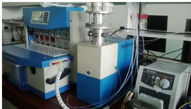
Слика 24. Уређај са проточним ћелијама за праћење брзине растварања/отпуштања
