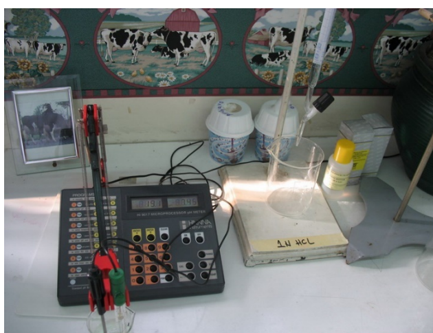
Priprema za titraciju i istiskivanje CO 2 čija količina se dalje detektuje promenama pH vrednosti uz primenu odgovarajućih jednačina
