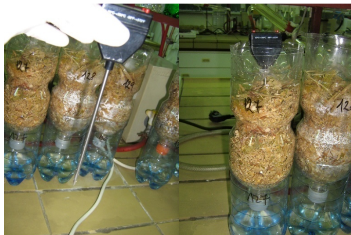
Slike 4.13 i 4.14 Praćenje promena temperature korišćenjem laboratorijskog ubodnog termometra
