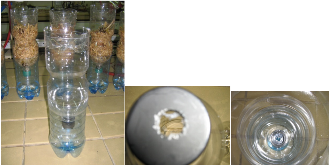
Slika 4.10 Izgled modifikovanih boca za test aerobne stabilnosti
