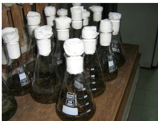
Slika 4.15 Uzorci senaža lucerke silirana 40 dana u fiziološkom rastvoru posle 168h testa AS
