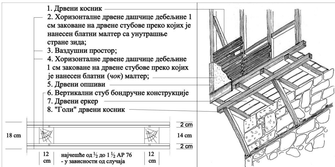
Слика 42. – Бондручни зид и слојеви бондручног зида – хоризонтални пресек (лево) Извор: Аутор и Аксонометријски приказ еркерног испуста (десно), Извор: Чипан, Б. (1982), стр.31.
