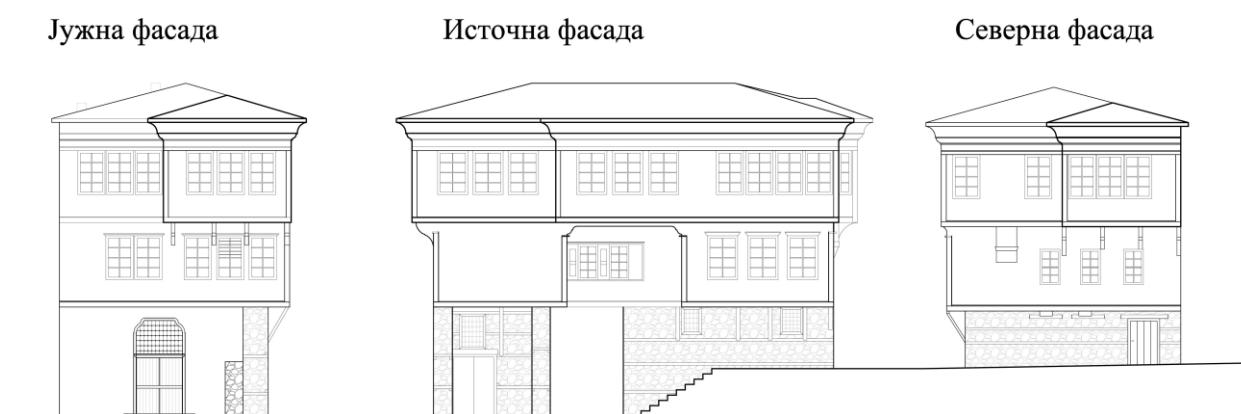
Слика 98. Прозорски отвори на јужној, источној и северној фасади куће Уранија, западна фасада не постоји, јер је кућа слепљена са другим објектом са западне стране (сл.73), Извор: Аутор
