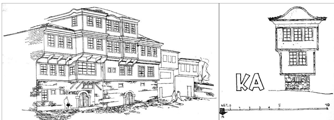
Слика 50. Барокне форме стреха, косника и крова изведене у бондручној конструкцији: Кућа породице Робеви где су спојене две парцеле да би се саградила кућа већих размера, Извор: Томоски, С. (1960), стр. 57. (лево) и Кућа породице Каневче - Главна фасада са заобљеним тимпаномом; Извор: Чипан, Б. (1982), стр. 102. (десно)
