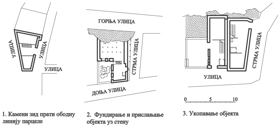
Слика 39. Варијантна решења у решавању проблема тесне и стеновите локације у Горњем граду
