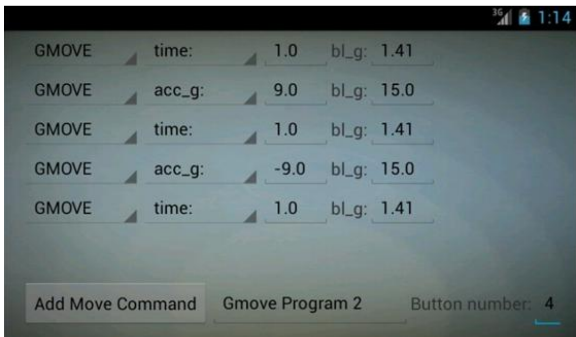
Слика 8.3 Графички кориснички интерфејс за програмирање кретања центрифуге
