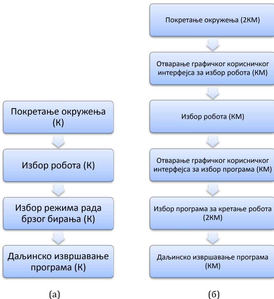
Слика 9.10 Кораци које је потребно извршити приликом даљинског покретања претходно дефинисаног програма (а) употребом предложеног “ speed dial ” решења и (б) употребом Лола УС-а базираног на употреби РС-ја за интеракцију са корисником, почевши од покретања окружења
