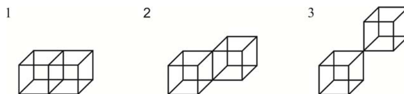
Slika 5. Ilustracija različitih energija veze dve izgrađivačke jedinice na pljosni kristala
