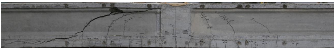
Slika P .9-10: 350-185/35: Prikaz prsline na južnom licu grede nakon loma
