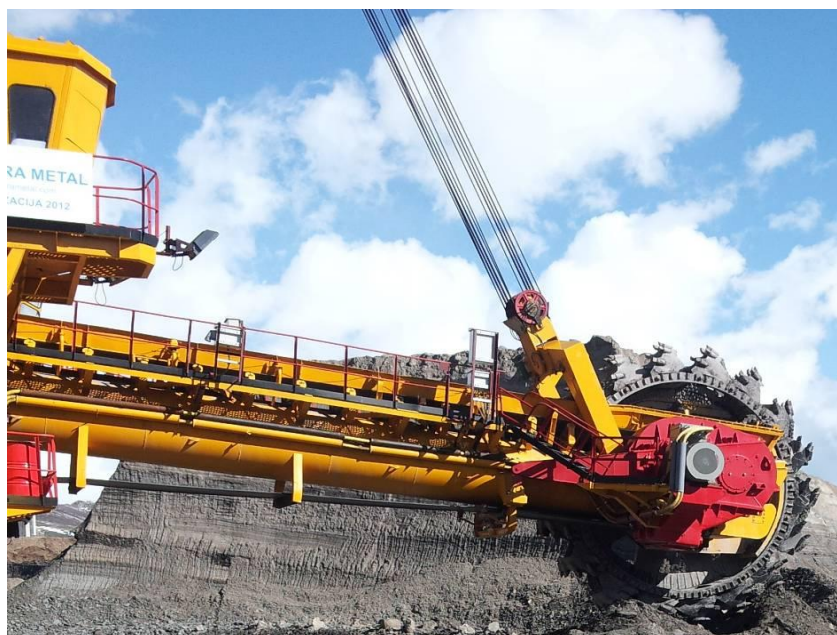
Slika 3.22. Rotor sa strelom rotora
