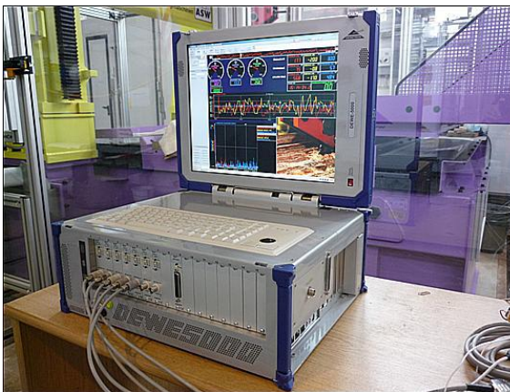
Slika 2.9. Računar DEWE 5000 sa prikazom merenja i video zapisom
