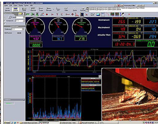
Slika 2.9. Računar DEWE 5000 sa prikazom merenja i video zapisom
