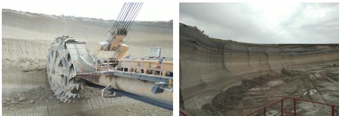
Slika 7.1. Rad rotornog bagera ER-1250 16/1,5 u bloku
