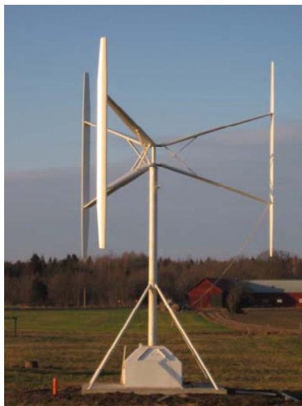
Слика 5.28. Ветротурбина номиналне снаге 12kW изведена на Универзитету у Упсали, преузето из [27]
