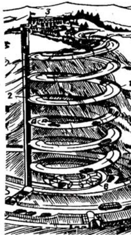
Slika br. 6 Aksonometrijski prikaz spiralne rampe: 1- spiralna rampa, 2- okno, 3- istovarna stanica
