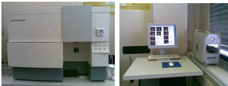
Slika 3. Protočni citofluorimetar i kompjuter - sistem za merenje i analizu podataka (FACSCalibur 4CS, BD Biosciences, SAD)
