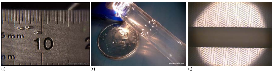
Слика 1.40. Микро сечење и бушење стакла примењено за све врсте стакла: а) сечење стакленог диска пречника 500 микрона - 0,5 mm, б) бушење рупа пречника 150 микрона по обиму стаклене цеви, и ц) ласерско бушење канала величине 2 микрона,
