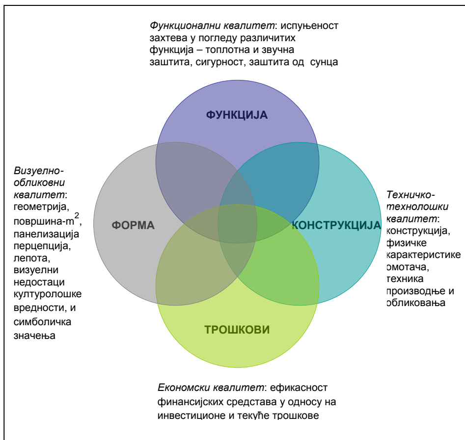
Слика 5.1. Оптимални укупни квалитет стакленог омотача подразумева оптималан однос визуелно-обликовних, функционалних, техничко-технолошких и економских карактеристика
