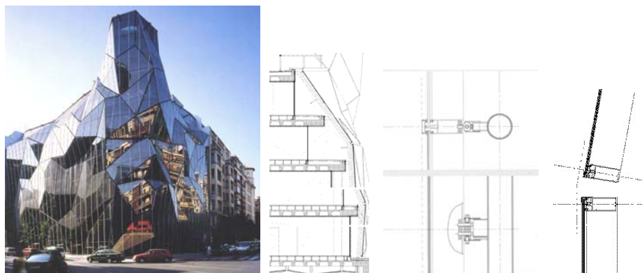
Слика П1.5. Изглед и пресек фасаде, основа и пресек детаља везе стаклених панела и потконструкције, и основа детаља везе панела под углом од 170^\circ , објекат Basque Health Department Headquarters , Билбао; (Извор: McLeod, 2010: 166)
