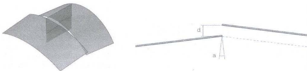
Слика П1.44. Могућа одступања приликом примене цилиндричних панела (Извор: Leduc et al., 2012: 95)
