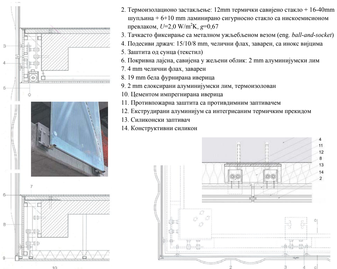
Слика П1.34. Основа, пресек и изглед детаља везе (тачкасто фиксирање) стаклених панела за бетонску међуспратну конструкцију, (Извор: "Administration Building in Istanbul", 2011: 65)
