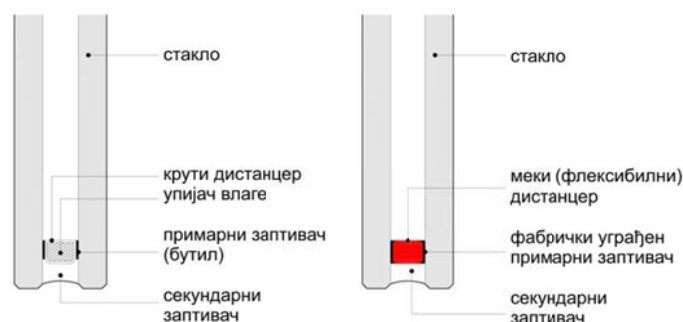
Слика 5.54. Примарни и секундарни заптивач термоизолационих панела са крутим и меким дистанцером; (Извор: према Guardian, 2012: 39)
