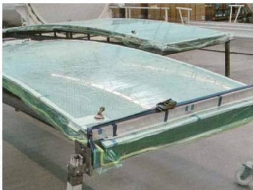
Слика 5.57. Савијање стаклених панела помоћу процеса ламинирања; (Извор: Molter & Wolf, 2011: 86)
