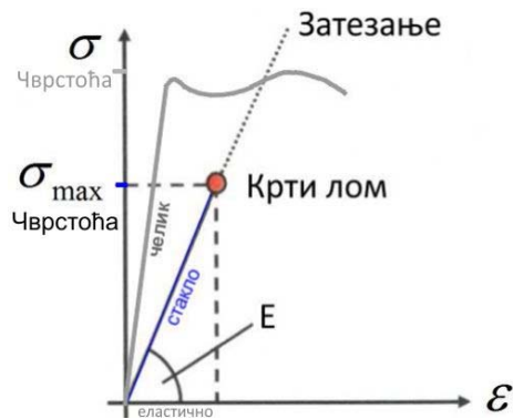
Слика 3.5. Однос напона и деформација за стакло и челик (Извор: Према Belis et al., 2013: 14)
