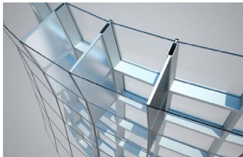
Слика 1.50. Двослојна структура полиедарских површи базирана на паралелној мрежи (Извор: Wallner and Pottmann, 2011: 4)
