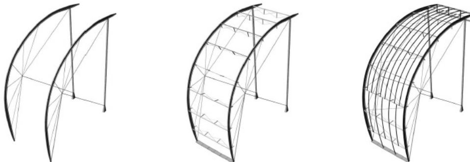
Слика П1.74. Хијерархија елемената челичне потконструкције (примарна, секундарна и терцијална) стакленог омотача железничке станице Strasbourg TGV , (Извор: Baldassini, 2008: 9)
