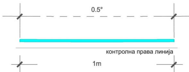
Слика 3.26. Минимална закривљеност стакла од 0.5^\circ по метру дужном (тешко уочљива у односу на контролну праву линију) коју је могуће постићи процесом хладног савијања стакла дебљине 15 mm
