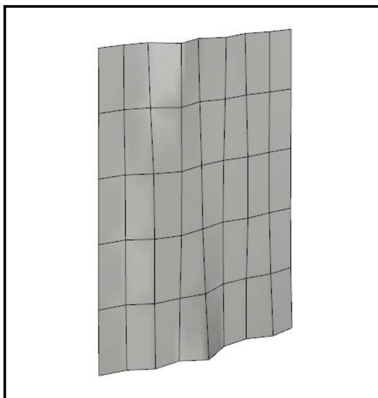
Слика 6.12. Модел 8-Хипар (ХП) (двоструко закривљени панели у форми хиперболичног параболоида са ивицама које су праве линије); (Извор: Аутор)
