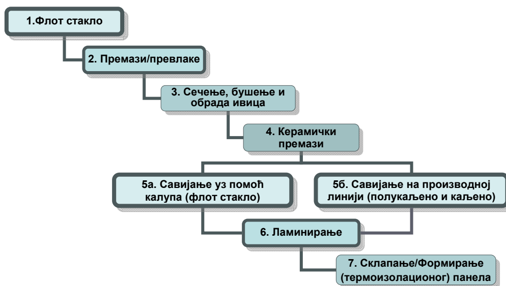
Дијаграм 3.1. Поступци/кораци у производном процесу термичког обликовања закривљеног стакла
