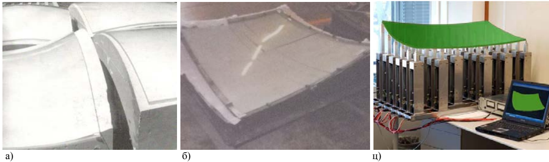
Слика 1.37. Обликовање стакла поступком термичког савијања уз помоћ калупа: а) Бетонски калупи произведени CNC бушилицом за фабрикацију двоструко-закривљених панела од акрилног стакла за омотач павиљона BMW Bubble Бернарда Франкенса (Bernhard Franken), 1999. год.; б) Метални калуп, фабрика SFL , Грац; ц) Подесиви калуп фирме Biradial Glass , Амстердам, Холандија; (Извор: а) Kolarevic, 2003: 35; б) Аутор, 2014; ц) Преузето са: www.biradialglass.com , 16. 2. 2016)
