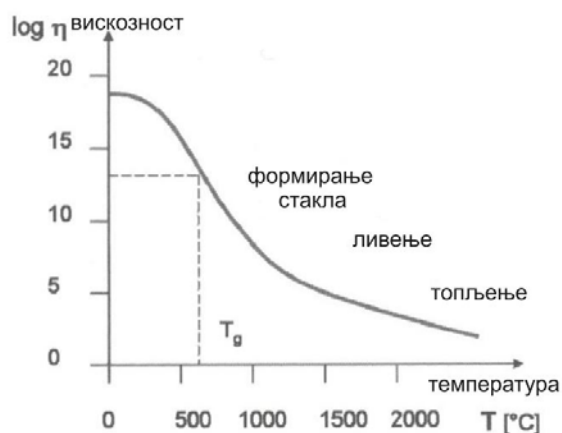
Слика 3.21. Вискозност стакла на високим температурама; (Извор: Neugebauer, 2013: 70)
