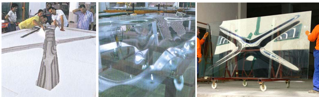
Слика П1.36. Постављање програмираних грејача у калуп X-облика преко којих је постављено стакло које је загревано у строго контролисаним условима и изглед добијене форме стаклених панела, (Извор: "Administration Building in Istanbul", 2011: 69)
