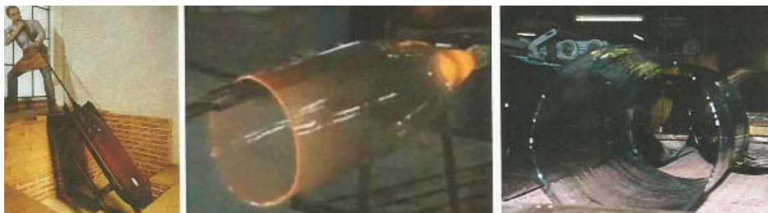
Слика 3.10. Технологија производње стакла - дувањем (Извор: Belis et al., 2013: 17)
