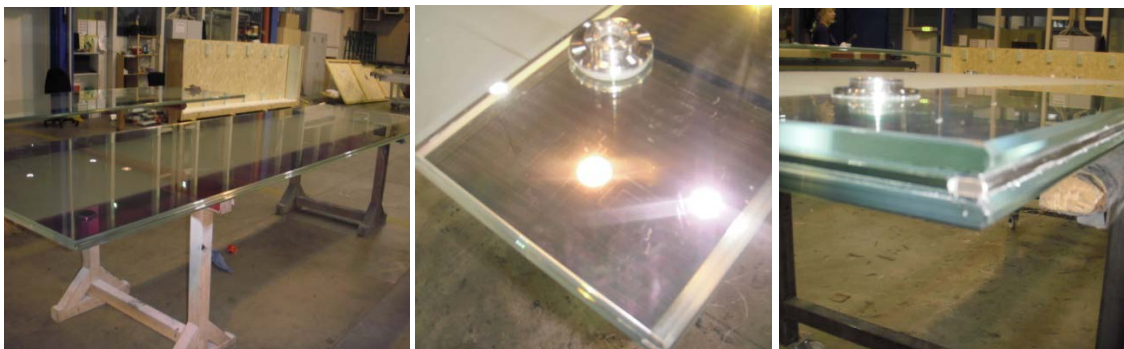
Слика П2.5. Формирање стакленог панела, који садржи 47 различитих елемената, за објект World Trade Center Tower One у Њујорку, фабрика SFL Technologies , Аустрија; специфичност ових панела представљају елементи од Dichroic стакла дебљине 6мм који су интегрисани у стаклени панел (Извор: Аутор, 2014)
