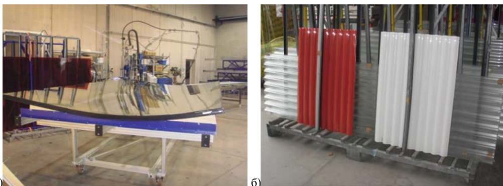
Слика 5.53. а) Формирање закривљеног термоизолационог панела са флексибилним синтетичким дистанцером у фабрици; б) Керамичка боја на таласасто закривљеном стаклу; (Извор: Аутор, 2014)
