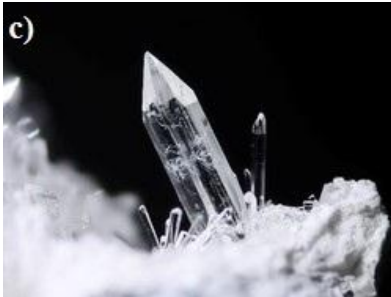
Слика 2. c) Изглед кристала еtringита (преузето: https://www.mineralienatlas.de/lexikon/index.php/MineralData?mineral=Ettringite )
