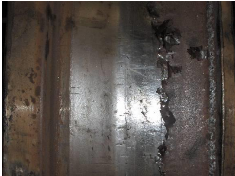
Slika 2.2 Pohabana gazna površina i venac točka
