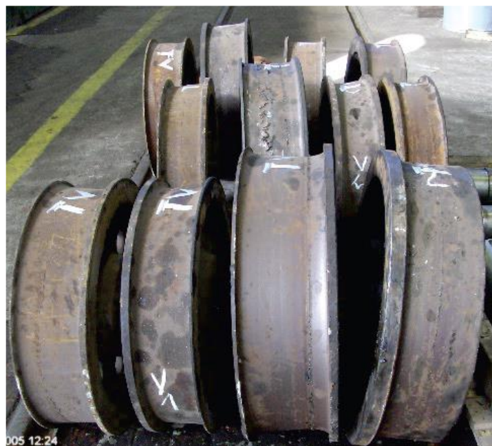
Slika 2.4 Pohabani točkovi dizalica poslani na reparaciju
