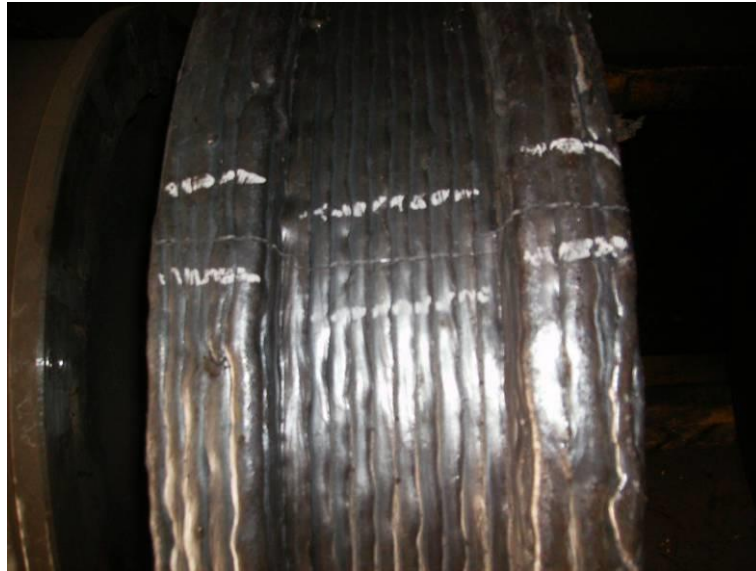
Slika 4.14. Prslina po celom preseku točka neposredno posle navarivanja II sloja
