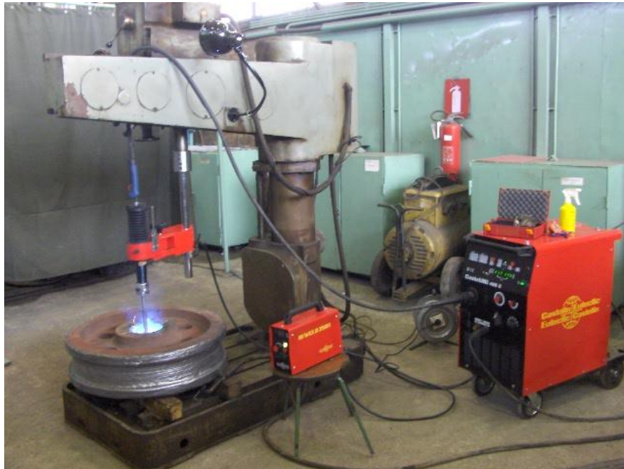
Slika 3.23 Navarivanje otvora točka
