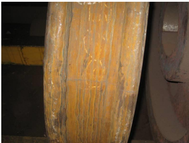
Slika 4.13. Prslina po celom preseku točka neposredno posle navarivanja
