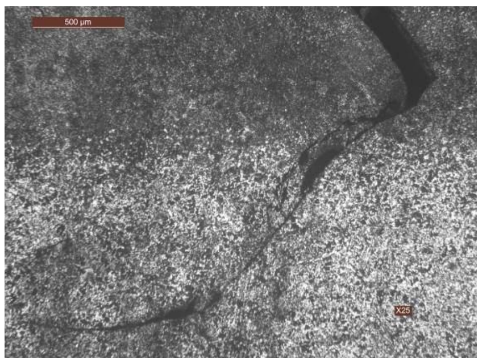
Slika 3.19 Mikrostruktura uzorka sa prslinom
