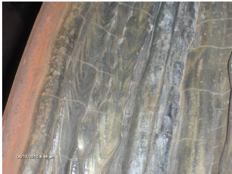
Slika 4.15. Prsline po celom obimu točka usled nekontrolisanog hlađenja
