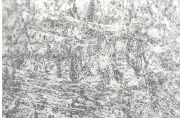
Slika 3.16 Mikrostruktura uzorka navarenog žicom FILTUB DUR 212
