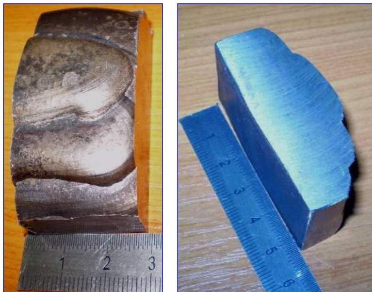
Slika 3.14 Uzorak navaren žicom Tube-Alloy 242-S
