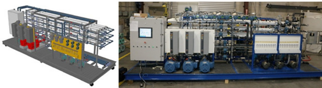
Слика 5.3. CAD 3D модел експерименталне инсталације за реверзибилну осмозу морске воде (лево) и израђена експериментална инсталација за реверзибилну осмозу морске воде (десно)
