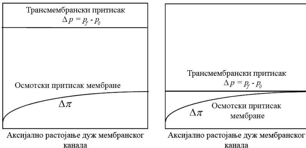
Слика 2.9. Приказ упоређивања трансмембранског притиска и осмотског притиска за (а) претходне технологије мембрана (лево) и (б) савремене мембране RO/NF
