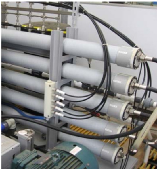
Слика 5.39. Експериментално постројење RO са NanoH 2 O мембранским модулима пречника 100 mm
