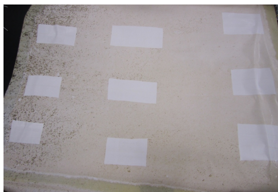
Слика 5.35. Мембрана са приказаним површинама за узимање узорака материјала
