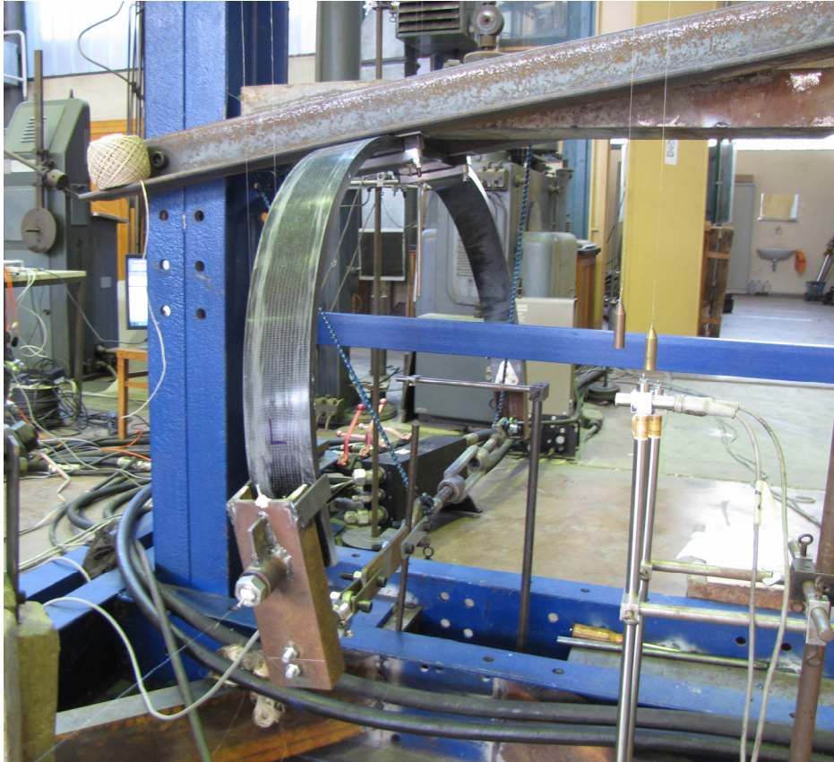
Слика 7.8 Испитивање композитног гибња бр. 4 у бочном правцу
