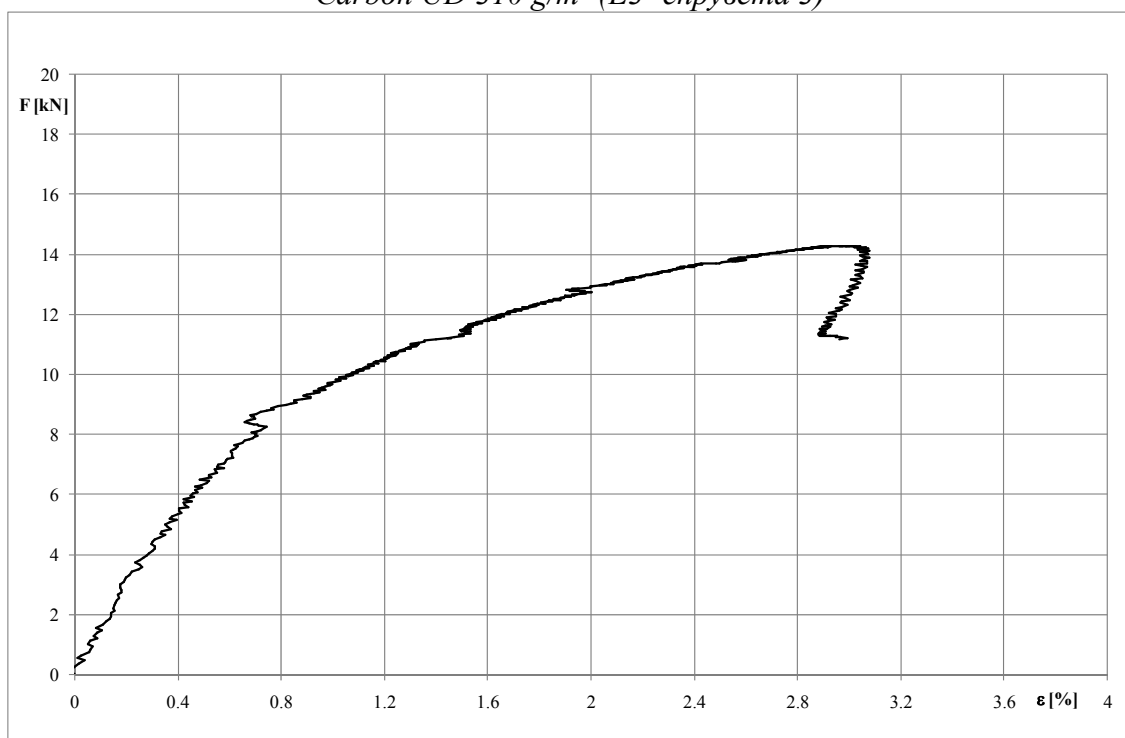
Слика 10. Дијаграм зависности сила-деформација материјала Carbon UD 310 g/m 2 (E4- епрувета 1)
