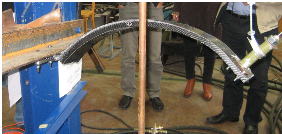
Слика 7.2 Испитивање гибња бр. 1 до лома (наставак)
