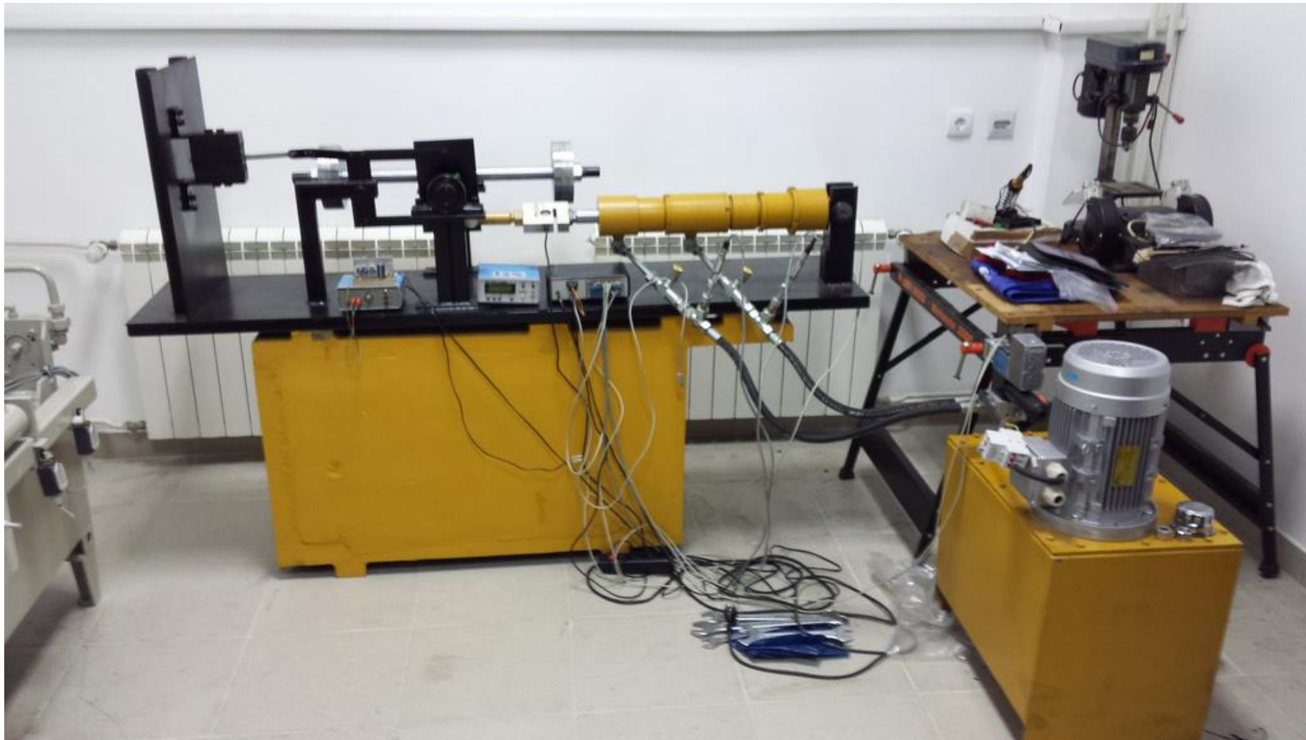
Слика 10.5а-Поглед са предње стране на комплетан систем актуатор, хидраулички агрегат и механички симулатор инерцијалног оптерећења и оптерећења на смицање
