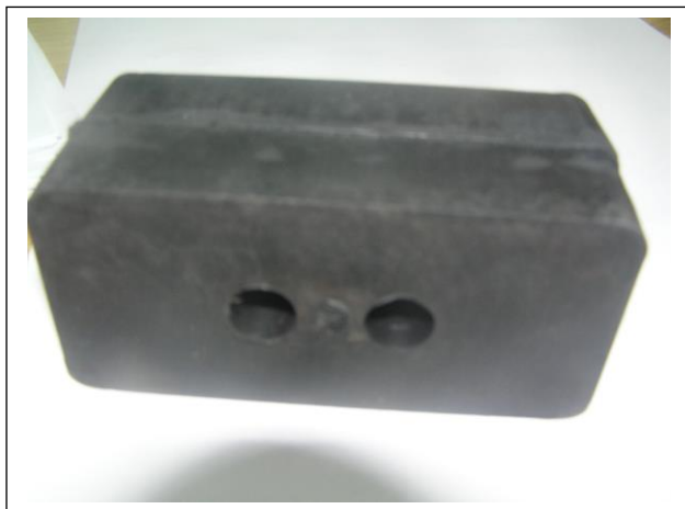
Слика 10.7-Фотографија гуменог блока за симулацију флексибилног оптерећења-оптерећење на смицање
