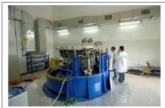
Слика 10.8-Испитивање управљања вектором потиска за ракетни мотор P80, ракета Вега [139]
