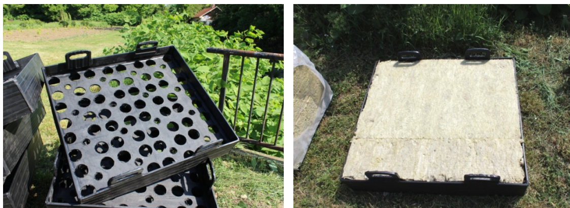
Slika 19. Pokretne rešetkaste platforme (levo) i kamena vuna u njima kao supstrat za sadnju biljaka (desno)
