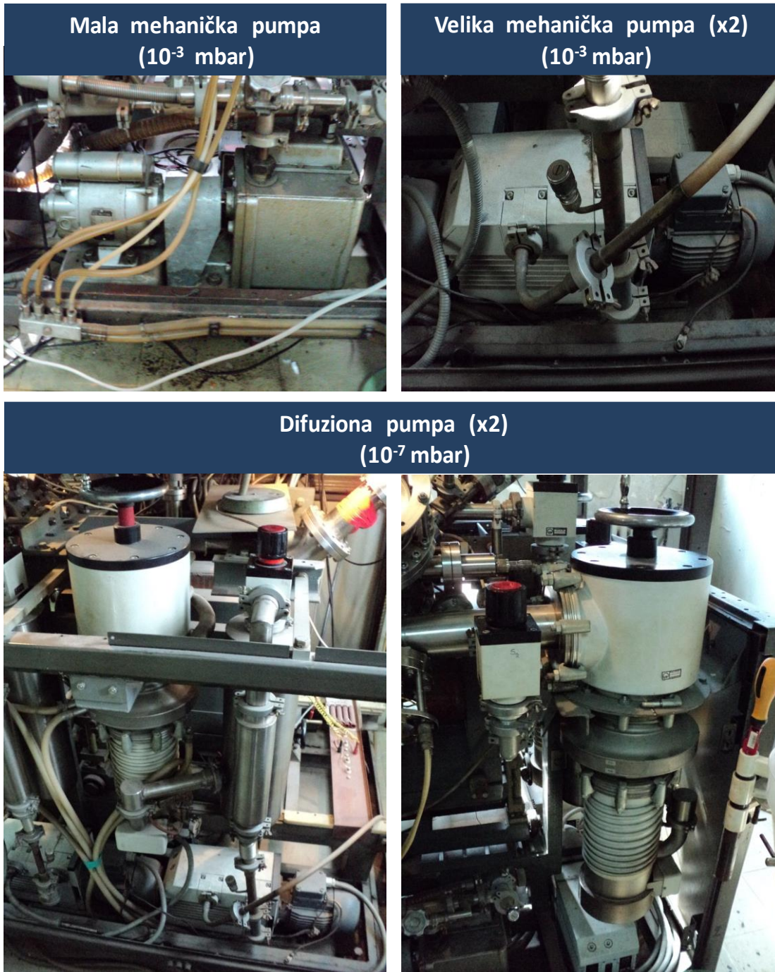
Slika 23. Pumpe vakuum sistema u masenom spektrometru tipa MS-1-MT.
