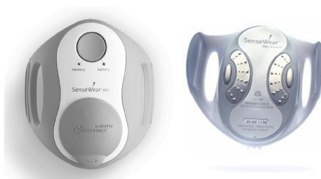
Slika 1. SenseWear Pro 3 Armband (SWA) višesenzorni uređaj za merenje fizičke aktivnosti i energetske potrošnje (sa prednje i zadnje strane)
