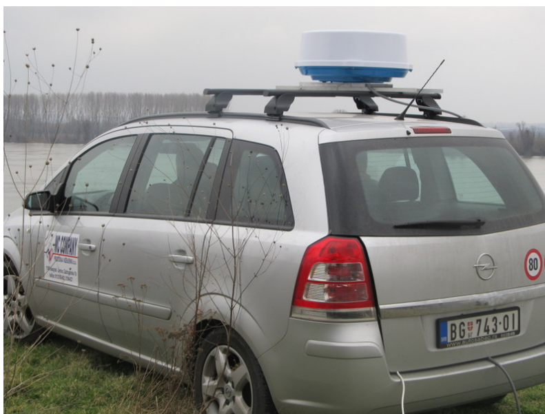
Slika 5.17: Izgled primopredajnika radara ONWA montiranog na putničkom vozilu za vreme funkcionalnog testiranja
