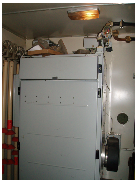
(c) Blok primopredajnika na radaru 9kr409
