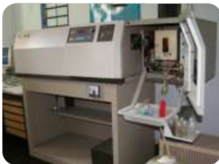
Slika 6.2.1.1. Atomski Emisioni Spektrometar sa indukovano spregnutom plazmom (ICP-AAS)
