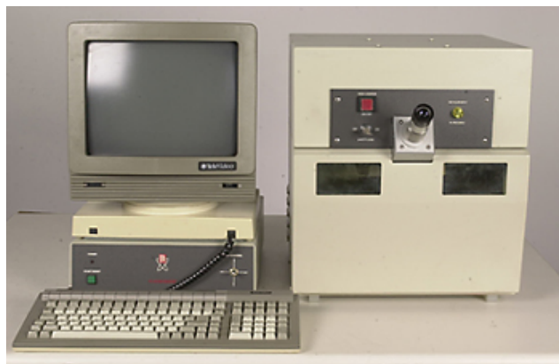
Slika 6.2.15.1 Aparat za merenje debljine prevlaka Fluoderm XRF-200
