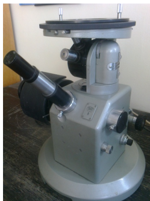
Slika 6.2.7.1 Optičko metalografski mikroskop model EPY TIP 2
