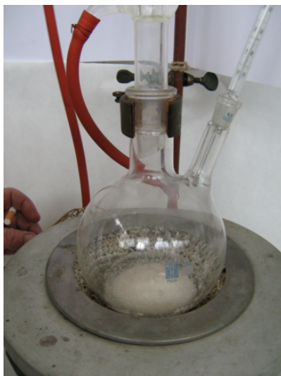
Slika 7.1.1.1 Balon sa rektifikacionom kolonom za sintezu merkaptotriazola
