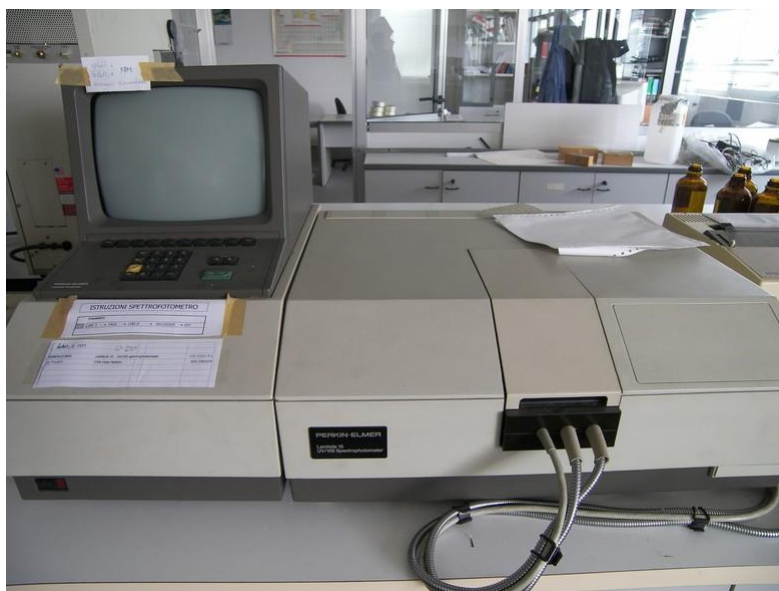
Slika 6.2.2.1 Perkin Elmer Lambda 15 UV-vis spektrofotometar
