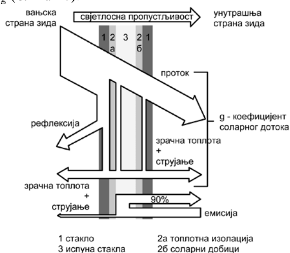
Слика А7. Шематски приказ пролаза сунчевог зрачења кроз композитно застакљење – двоструко (Hegger M., Auch-Schwelk V., Fuchs M. and Rosenkranz T, Construction Materials Manual , Basel; Boston; Berlin: Birkhäuser, 2006., стр. 154)
