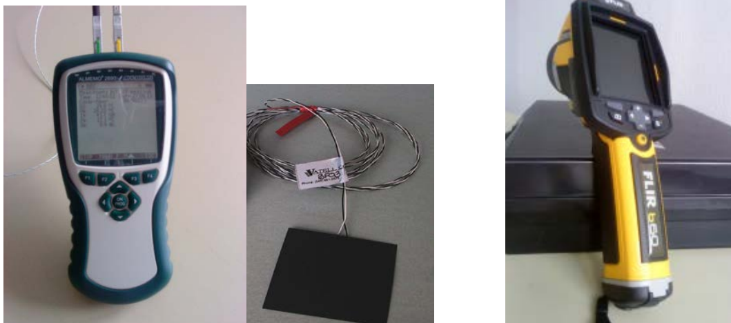
Слика А9. Уређаји за анализу топлотних карактеристика омотача Архитектонско-грађевинског факултета Универзитета у Бањој Луци – лијево вишеканални мјерни уређај ALMEMO ALBHORN 2690-8 и метална плочица за директно мјерење топлотног флукса и десно термографска камера FLIR b60
