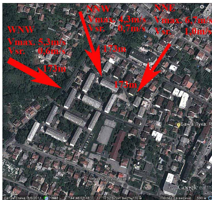
Слика 54. Прорачунати параметри максималне и средње брзине вјетра у стамбеном блоку дијела насеља Кочићев вијенац (Чаире) према доминантим вјетровима за подручје града Бањалука
