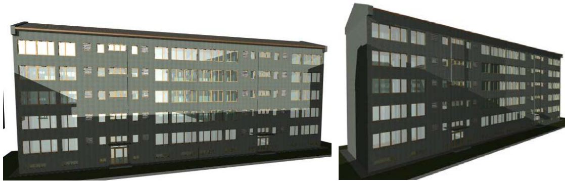
Слика 95а. Приказ осунчаности модела постојећег стања Узорка 1 (југоисточна фасада), слика лијево 22. децембар у 9 часова, слика десно 22. децембар у 13 часова
