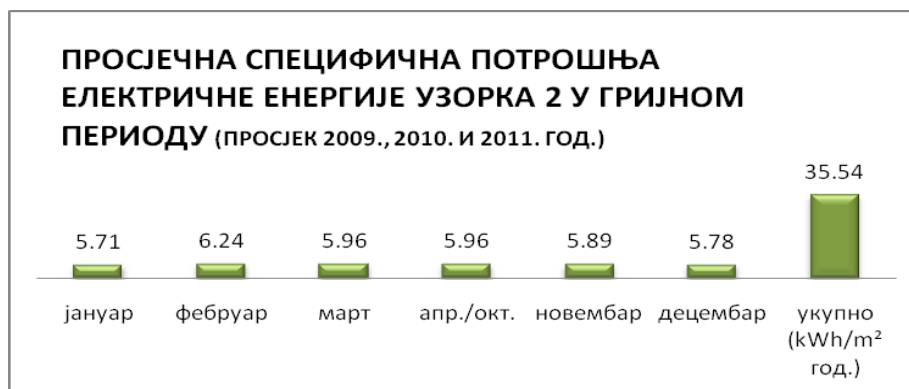
Графикон 54. Просјечна специфична потрошња електричне енергије узорка 2 према мјесецима и на годишњем нивоу за гријни период (просјек три године)
