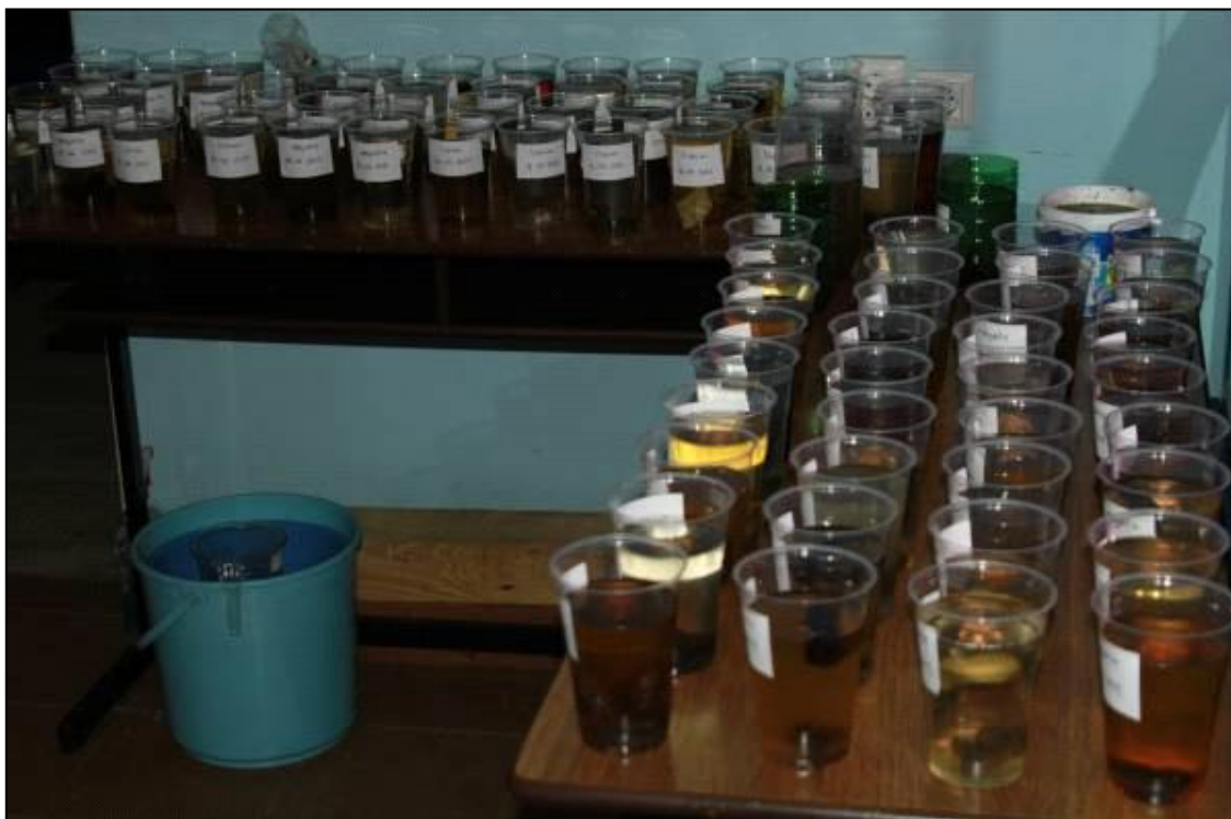
Slika 15. Potapanje uzoraka u vodu
